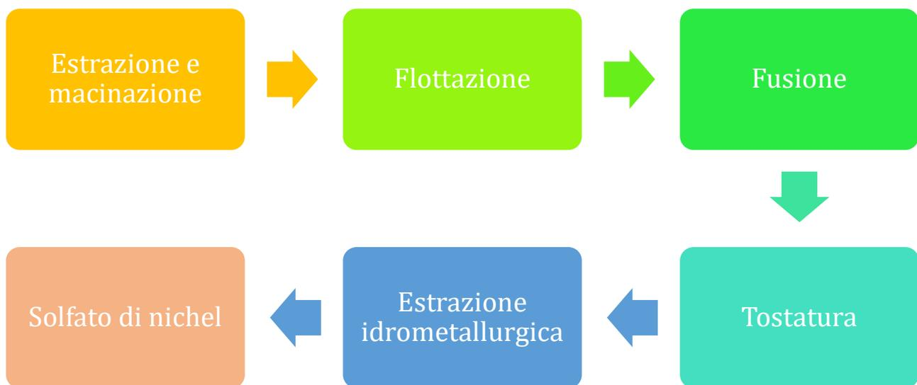
Figura 18: processo di produzione del nichel.
