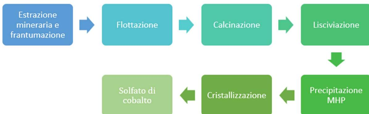
*Figura 21: processo di produzione del cobalto.*
