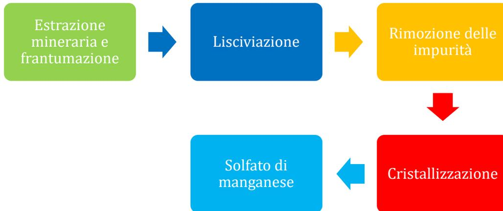
Figura 24: processo di produzione del manganese.
