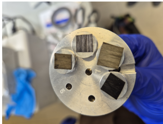
Figura 36: Sede dei campioni per l'analisi SEM-EDS
