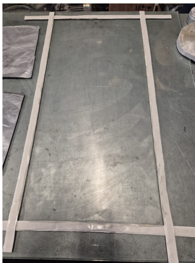
Figura 41: Vetro di lavoro del composito con zona di lavoro delimitata dal sealant tape
