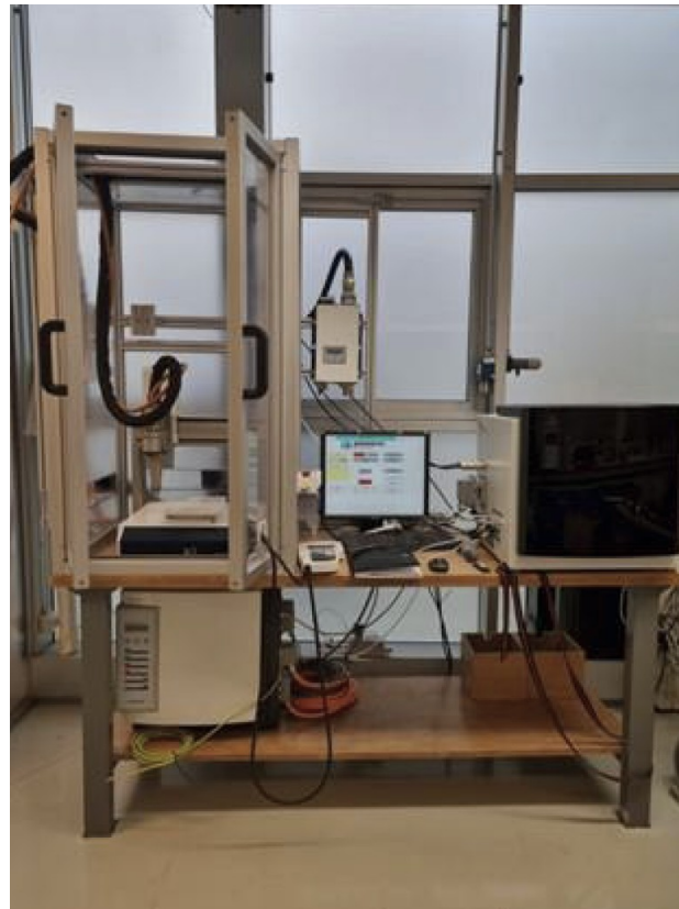
Figura 19: Banco di prova dell'impianto di trattamento al plasma con tecnologia APP
