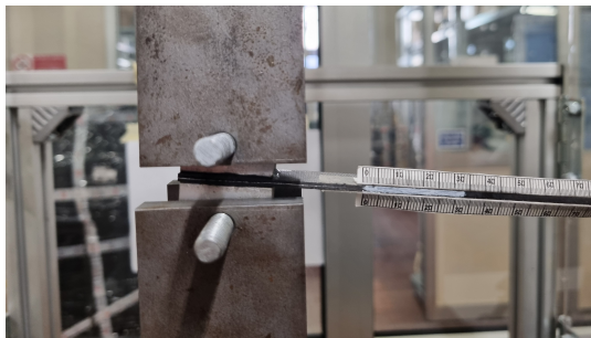
Figura 52: Provino montato nella macchina di prova MTS per mezzo di pin
