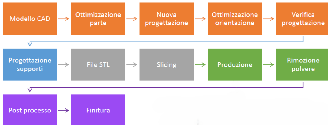
Figura 1.1: Ciclo di produzione di un componente AM [1]
