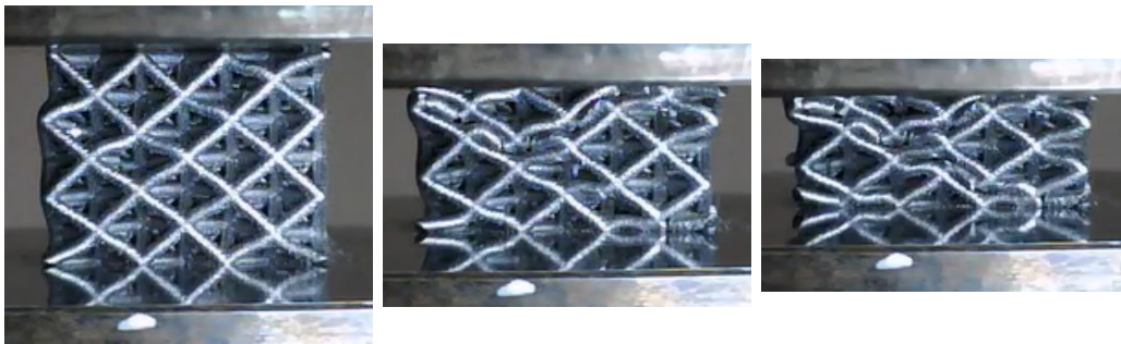
Figura 5.7: Sequenza di rottura provino HT300 cella 3x3x3 Test 1
