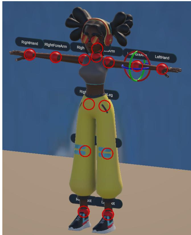
**Figure 3.6:** Posing tramite cinematica diretta: catene di handle (con nome a vista delle corrispondenti ossa) con Gimbal per il controllo delle rotazioni
