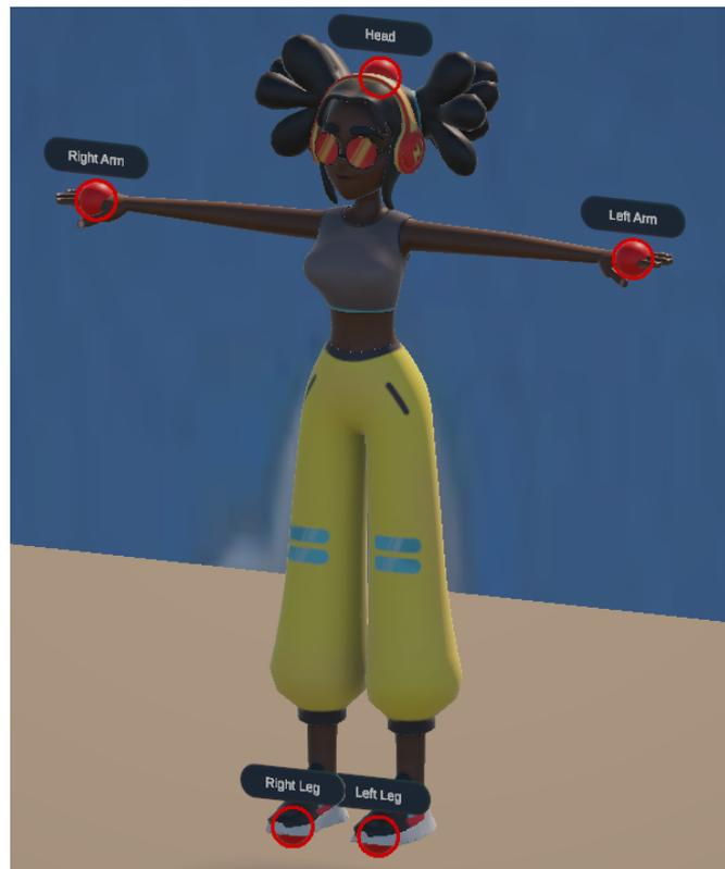
**Figure 3.7:** Posing tramite cinematica inversa: target (con nome a vista delle relative catene) in corrispondenza degli end effector per il controllo delle catene cinematiche
