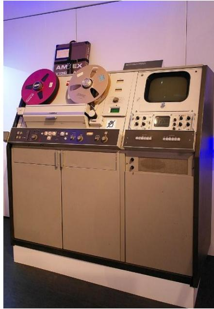
Figura I.3: l'Ampex VR-200, uno dei principali hardware usati per il montaggio lineare basato su tecnologia quadruplex
