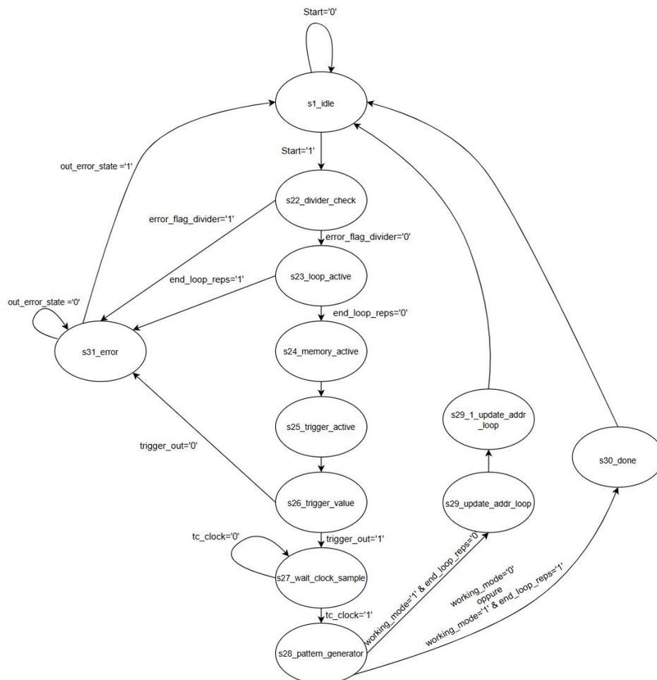
**Figura 3.5:** Sezione dell'unità di controllo del "Pattern Generator" relativa alla generazione dei pattern
