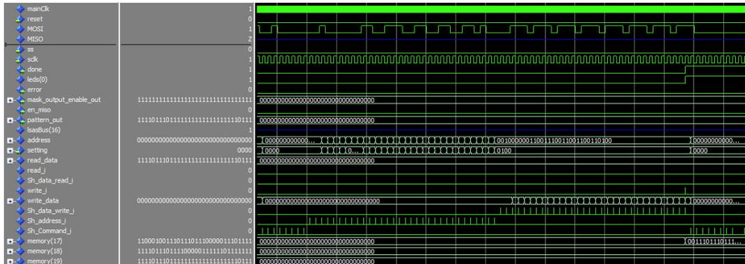
**Figura 3.17:** Simulazione relativa alla scrittura del pattern in memoria in modalità one-shot dal punto di vista sistemistico
