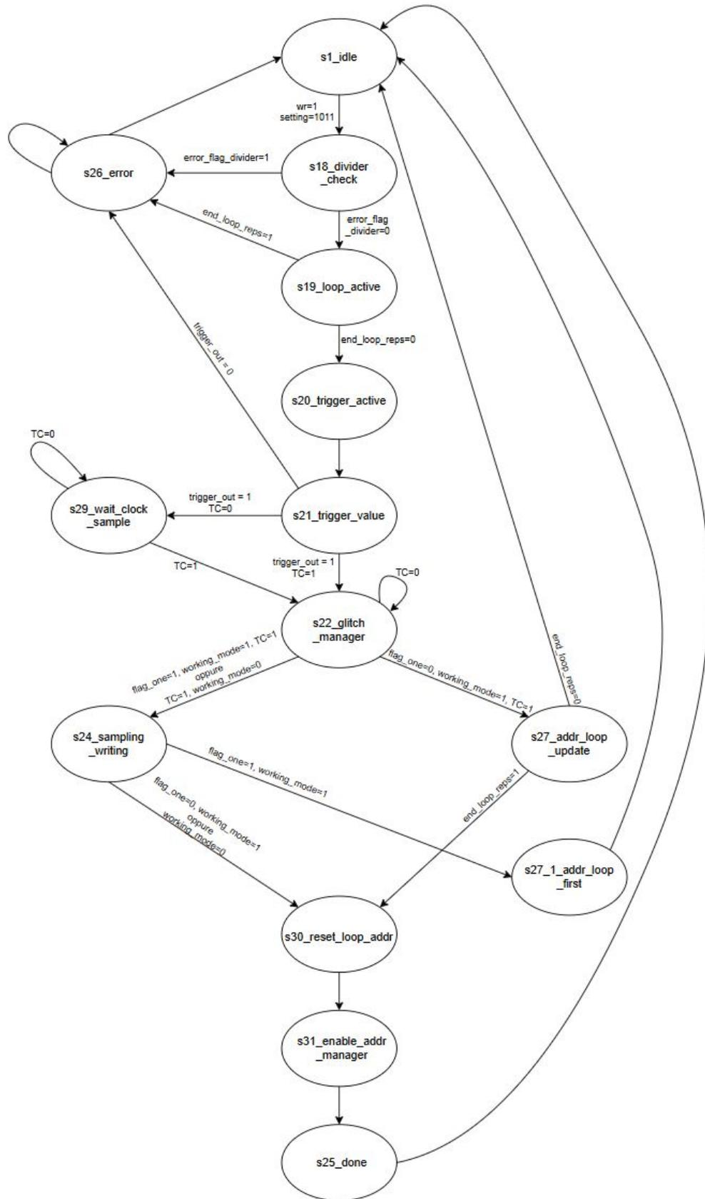
**Figura 4.7:** Sezione dell'unità di controllo del "Logic Analyzer" relativa al segnale da analizzare con conseguente scrittura dei campioni e glitch
