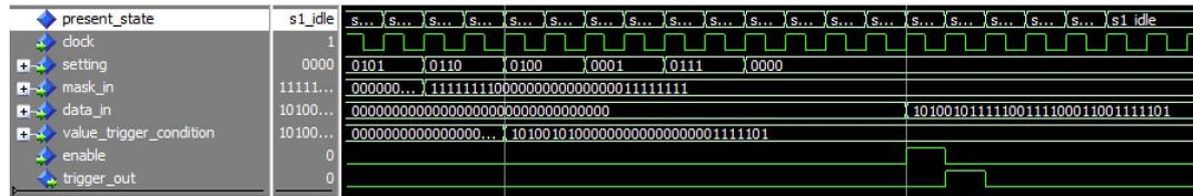
Figura 3.12: Simulazione relativa al Trigger Manager
