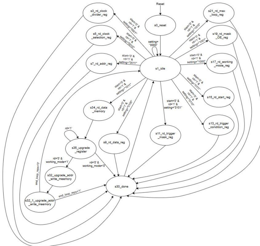
**Figura 3.4:** Sezione dell'unità di controllo del "Pattern Generator" relativa alla lettura dei registri
