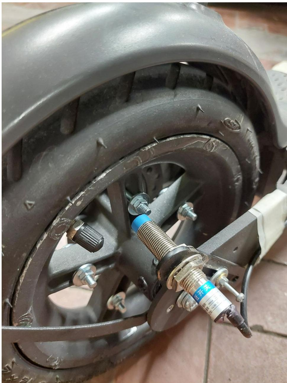
Figura 2.1: Sistema per la rilevazione della velocità angolare posteriore
