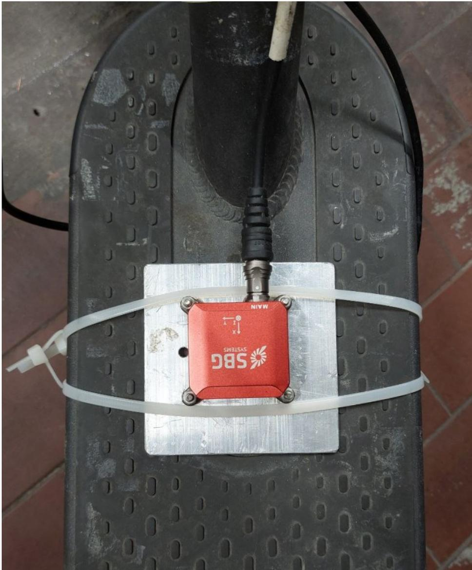
Figura 2.2: Posizione della IMU con relativo sistema di riferimento
