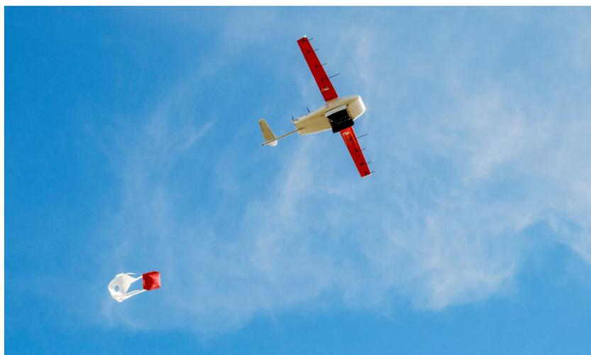
**Figura 1.5:** Drone della flotta di FlyZipline durante la consegna del payload. <https://www.flyzipline.com/technology>.
