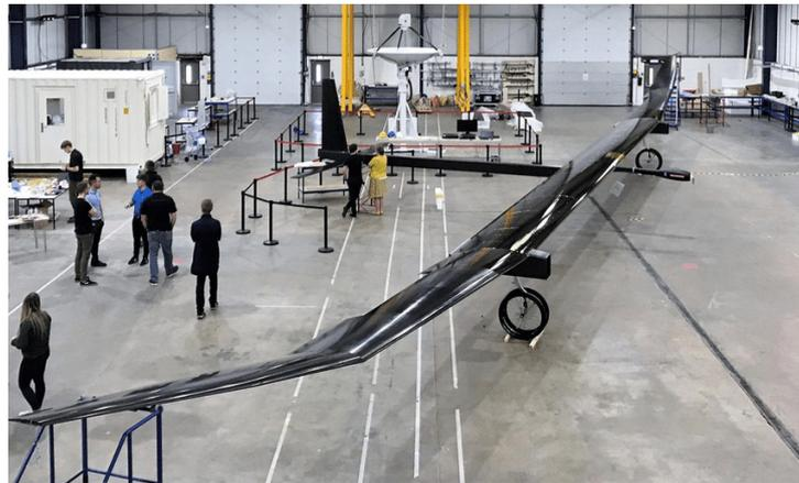
**Figura 1.3:** UAV PHASA-35, costruito da Prismatic per BAE Systems [10].
