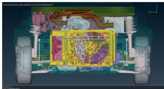
Figura 6.15: Modello di porosità del radiatore:  $p = 0.6$ .
