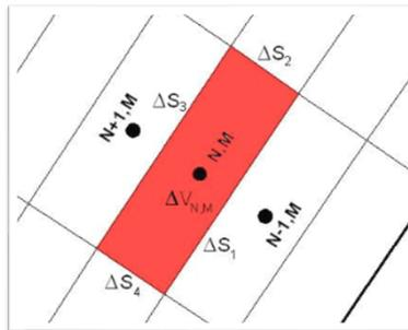
Figura 2.1: Esempio di cella computazione: CFD ai volumi finiti
