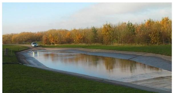
Figura 1.2: Esempio di *wading test* effettuato da Jaguar Land Rover JLR[3].
