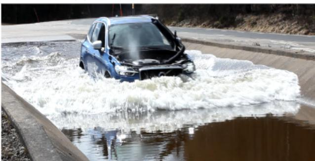
Figura 1.1: Esempio di *wading test* effettuato da Volvo[2]. Altezza del guado pari a 400 mm e velocità del veicolo di circa 12 km/h.
