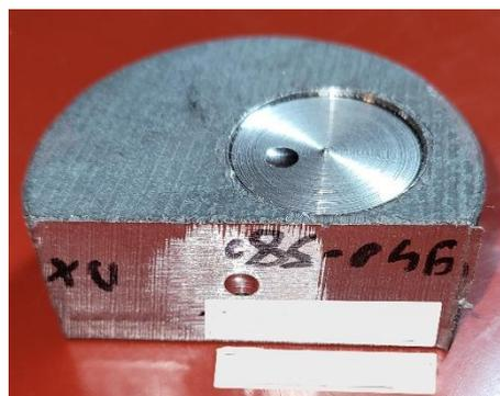
Figura 7.13: Provino sul quale è stata effettuata la prova di durezza
