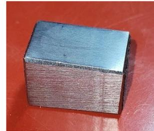
Figura 7.8: Porzione asportata da provino con superficie d'analisi adeguatamente preparata
