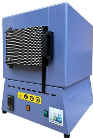
In Fig.7.2 è rappresentata la muffola da laboratorio utilizzata presso BTT S.R.L. per l'esecuzione delle varie prove. La muffola elettrica possiede una potenza di 4kW ed è dotata di elementi riscaldanti protetti "immersi" in fibra ceramica, consentendo un riscaldamento uniforme su quattro lati. Il volume interno possiede le dimensioni: b 210 [mm] x l 320 [mm] x h 145 [mm]. Come si vedrà nel *Paragrafo 7.3*, in realtà sono state utilizzate due muffole elettriche (uguali).
