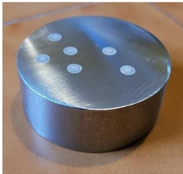
Figura 7.6: Segni superficiali su di un provino a seguito della prova quantometrica
