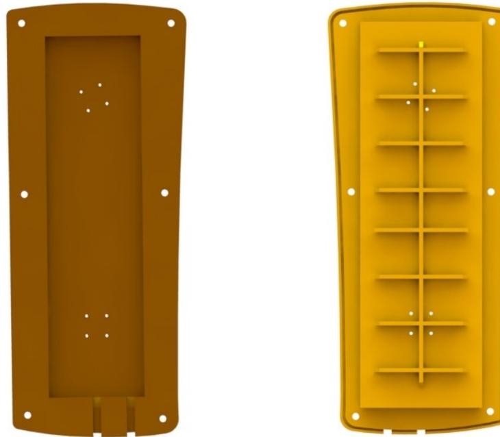
L'interfaccia tra la parte inferiore della pedaliera e le celle di carico, rappresentata in figura, presenta una cavità centrale piana su cui fissare le due celle di carico, ciascuna con 4 viti M2, e 6 fori corrispondenti a quelli presenti sulla parte inferiore della pedaliera per permettere il fissaggio ad essa con delle viti.
