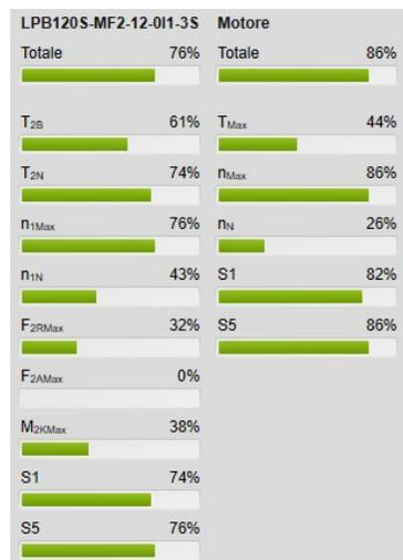
Figura 5.27: Percentuali utilizzo riduttore e motore
