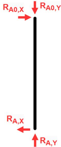
Figura 9.8 - Diagramma corpo libero link 1
