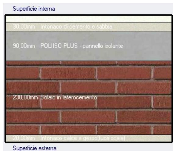
**Figura 13:** Stratigrafia solaio interpiano piano terra – piano primo (Palazzina T).
