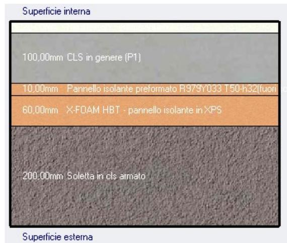
**Figura 11:** Stratigrafia pavimento contro terra.
