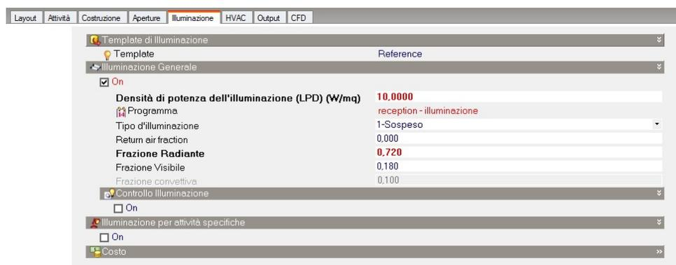
Figura 23: *Esempio compilazione scheda "illuminazione" per reception piano terra palazzina S.*
