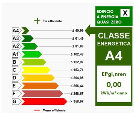
Figura 43: Classe energetica dell'edificio di nuova costruzione
