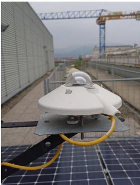
Figura 4-6: Esempio di piranometro
