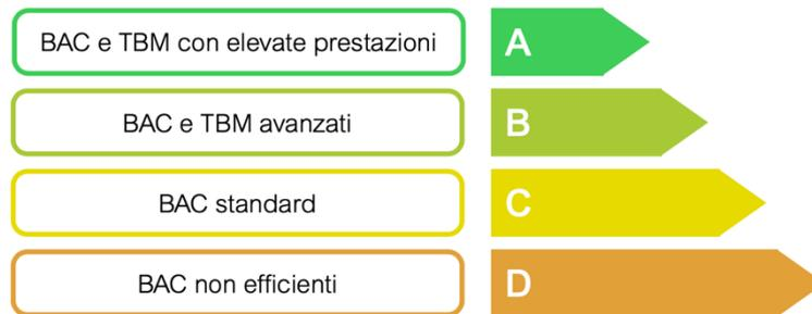
Figura 18 - Classi di automazione BACS secondo la EN ISO 52120:1-2022 (13)
