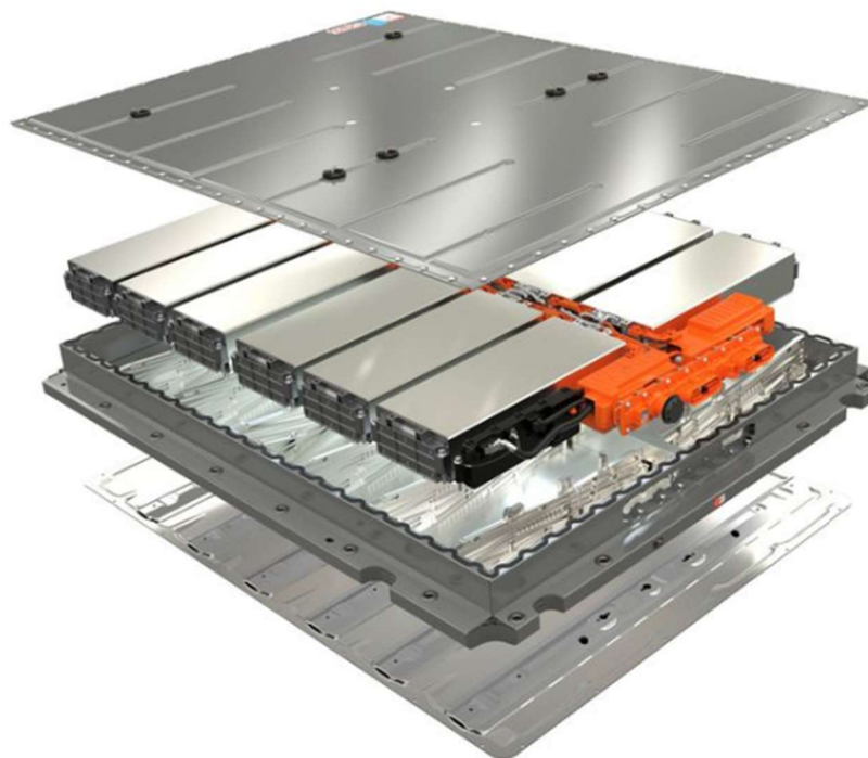
Figura 11: Struttura batteria agli ioni di litio di un'auto elettrica VW ID [11]
