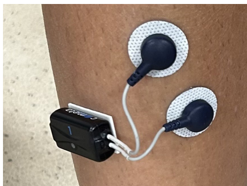
Figura 33: Esempio di elettrodi ed EMG posizionati sul tibiale anteriore.
