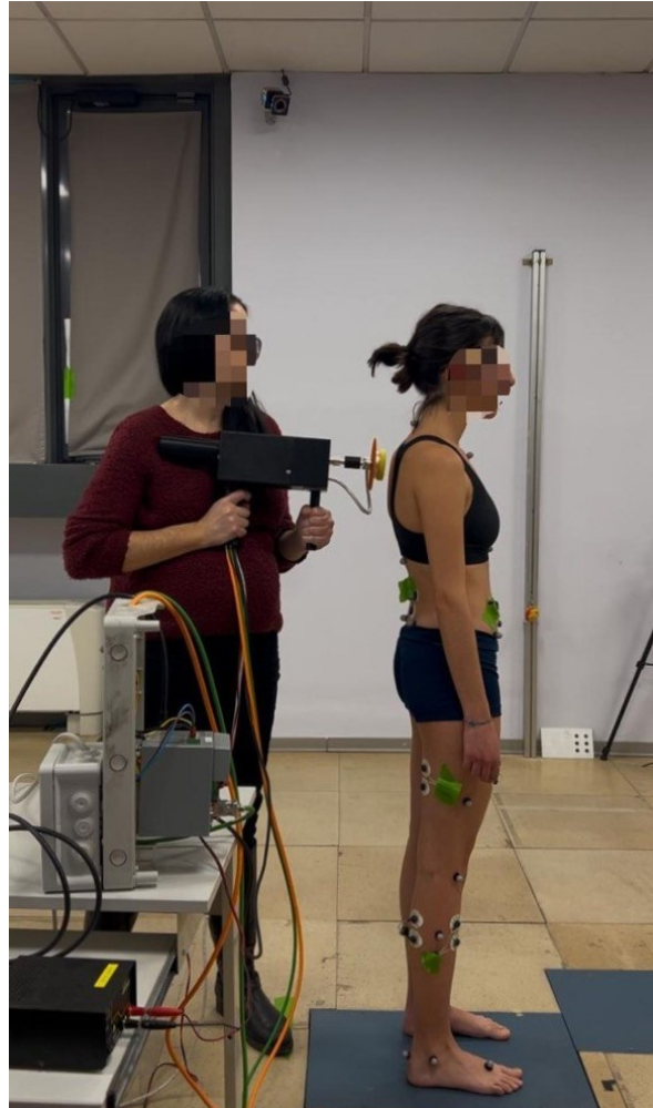
Figura 44: Rappresentazione della configurazione sperimentale: il soggetto è posizionato in piedi al centro della pedana di forza, mentre l'operatore, alle sue spalle, tiene in mano il perturbatore.
