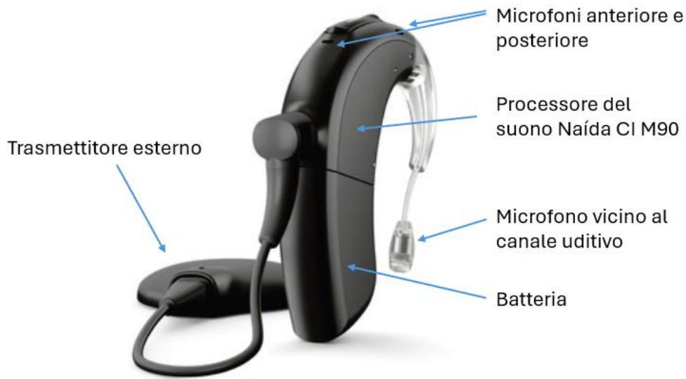
Figura 12: Esempio di processore del suono (Processore sonoro Naida CI M90 di Advanced Bionics). Nella figura si possono notare i componenti fondamentali del processore esterno: il trasmettitore esterno a radiofrequenza, la batteria, il DSP e i microfoni. Figura presa e modificata da [20].
