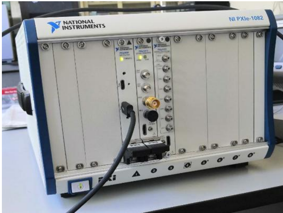
Figura 29: PXIe-1082 utilizzata. La scheda di generazione dei segnali PXIe-5413 dispone di due canali di generazione di segnali, sebbene nel nostro caso è stato utilizzato un solo canale. Una parte fondamentale di questa scheda sono i due led. I led sono necessari per il controllo della misura da parte dell'operatore in quanto fornisce informazioni sulla generazione del segnale. La scheda di acquisizione dei segnali PXIe-5172 svolge il ruolo di oscilloscopio. È dotata di 8 canali di lettura da poter usare contemporaneamente.
