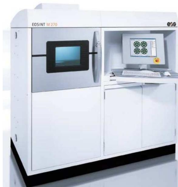
Figura 14. Macchina EOSINT M 270: Sistema per la produzione additiva per fusione di metalli [26]
