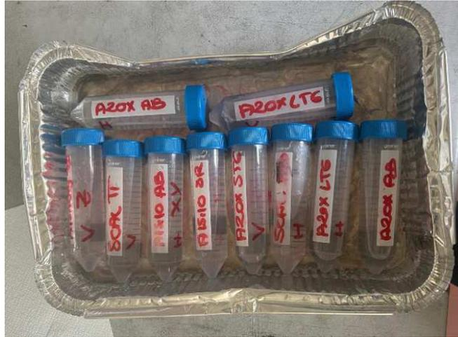
Figura 23. Disposizione dei campioni delle tre leghe per il test di esposizione prolungata alla soluzione corrosiva di acqua e glicole etilenico
