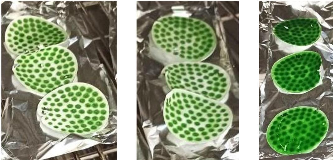
**Figura 2.26** Variazione di colore dei filtri col passare del tempo, dovuta all'aumento della concentrazione di biomassa.
