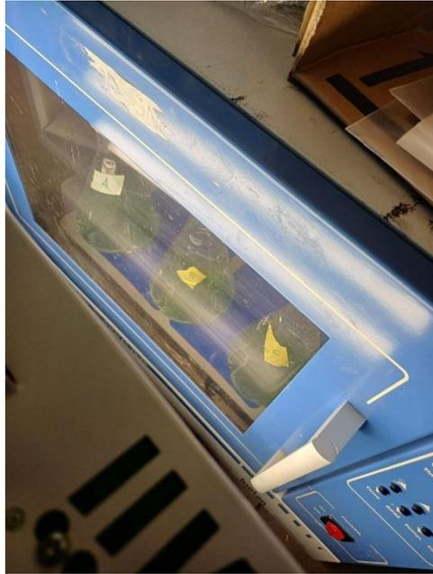
**Figura 2.18** Oblò dell'incubatore: le beute sono posizionate il più vicino possibile alla lampada poggiata sull'incubatore.
