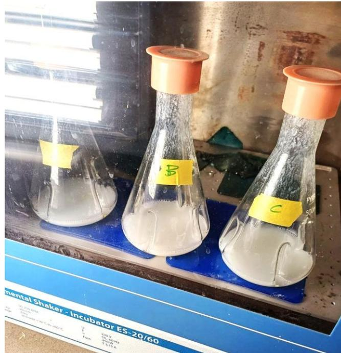
**Figura 3.3** Colonie microalgali dopo meno di 8 ore dall'inoculo con la soluzione GLUC1. L'assenza di verde è sintomatica della morte.
