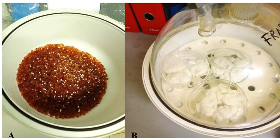
**Figura 2.6** (A) Essiccatore contenente sfere di silice; (B) essiccatore contenente i campioni, sottovuoto.
