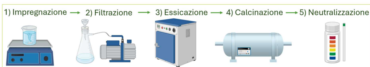
Figura 17 - Processo di post-attivazione chimica
