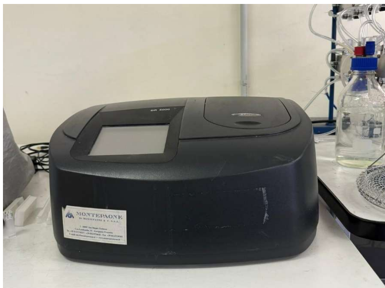
Figura 21 - Spettrofotometro UV-visibile utilizzato per l'analisi
