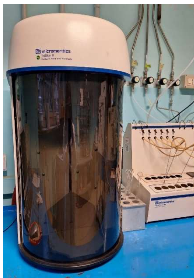
Figura 19 - Strumento di fisisorbimento in azoto a 77 °K Tristar II Plus della Micromeritics
