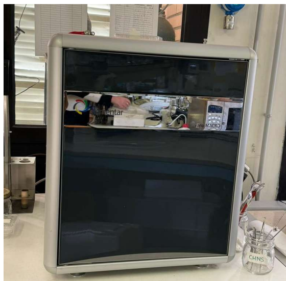
Figura 18 - Analizzatore elementare CHNS MacroCube di Vario NC Technologies
