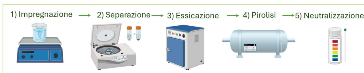
Figura 16 - Processo di pre-attivazione chimica two-steps
