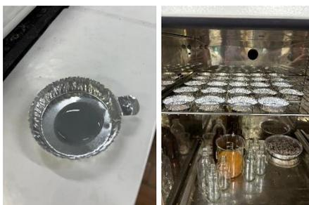
**Figura 13:** disco contenente 2 g di fango prima di essere posto in stufa; dischi inseriti in stufa a 110 °C.
