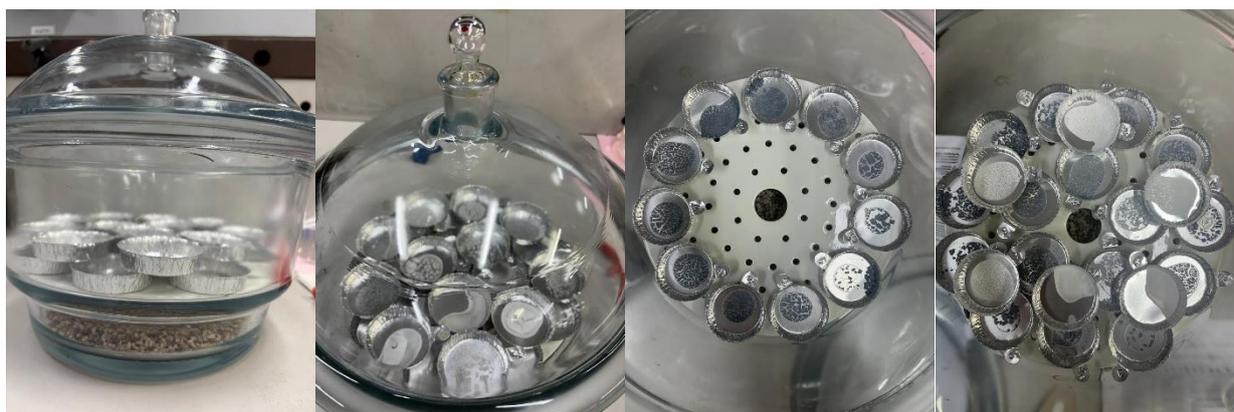
Figura 15: essiccatore contenente un disco forato in ceramica sotto il quale è presente il gel di silice.
