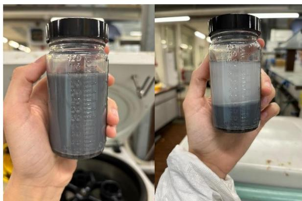
**Figura 12:** campione di 100 ml di fango prima e dopo la centrifugazione.
