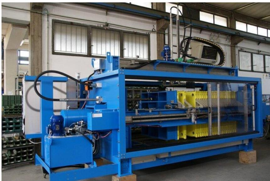
**Figura 8:** Filtropressa a piastre usata per la disidratazione dei fanghi industriali.
