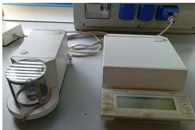
**Figura 4.6** Bilancia microanalitica Mettler MT5
