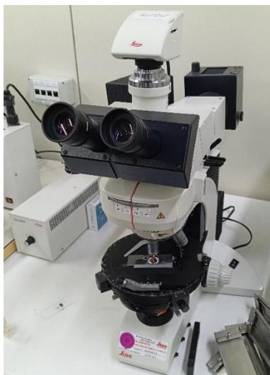
**Figura 4.14** Microscopio ottico Leica DMLP
