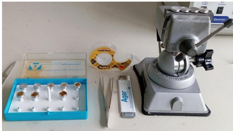
**Figura 4.9 Kit di preparazione dei campioni per la SEM**
