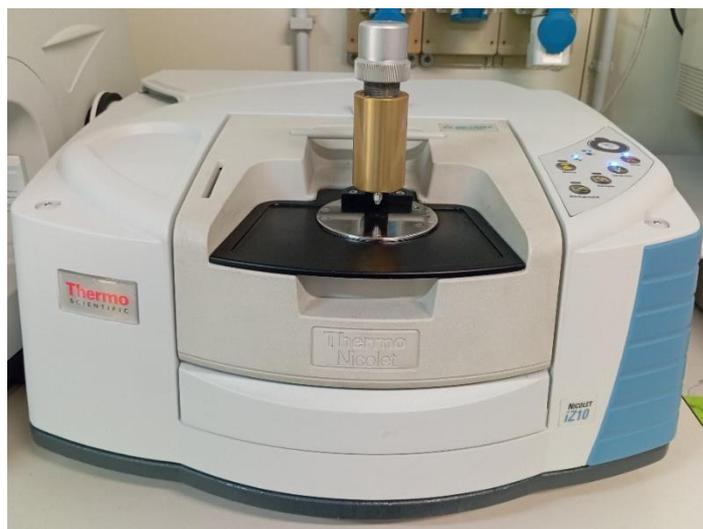
**Figura 3.7** FT-IR NEXUS Thermo Nicolet con dispositivo ATR
