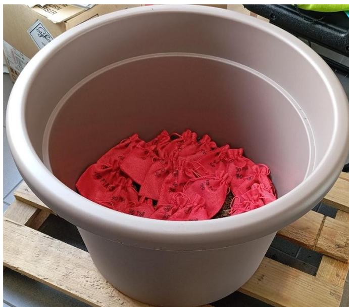
**Figura 4.20** Vaso con film di PVA/proteine con diverse composizioni all'interno di sacchetti di PET
