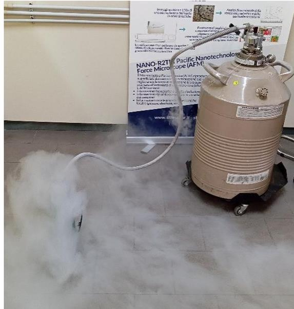
**Figura 4.15** Serbatoio criogenico di azoto liquido
