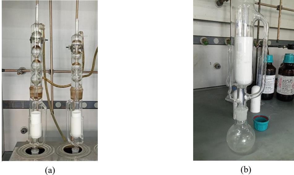
**Figura 3.12** Estrattori Soxhlet (a) e assemblamento nel pallone con la camera di estrazione (b)
