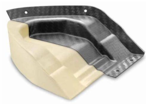
Figura 13: Core in Intivato, preformato [18]
