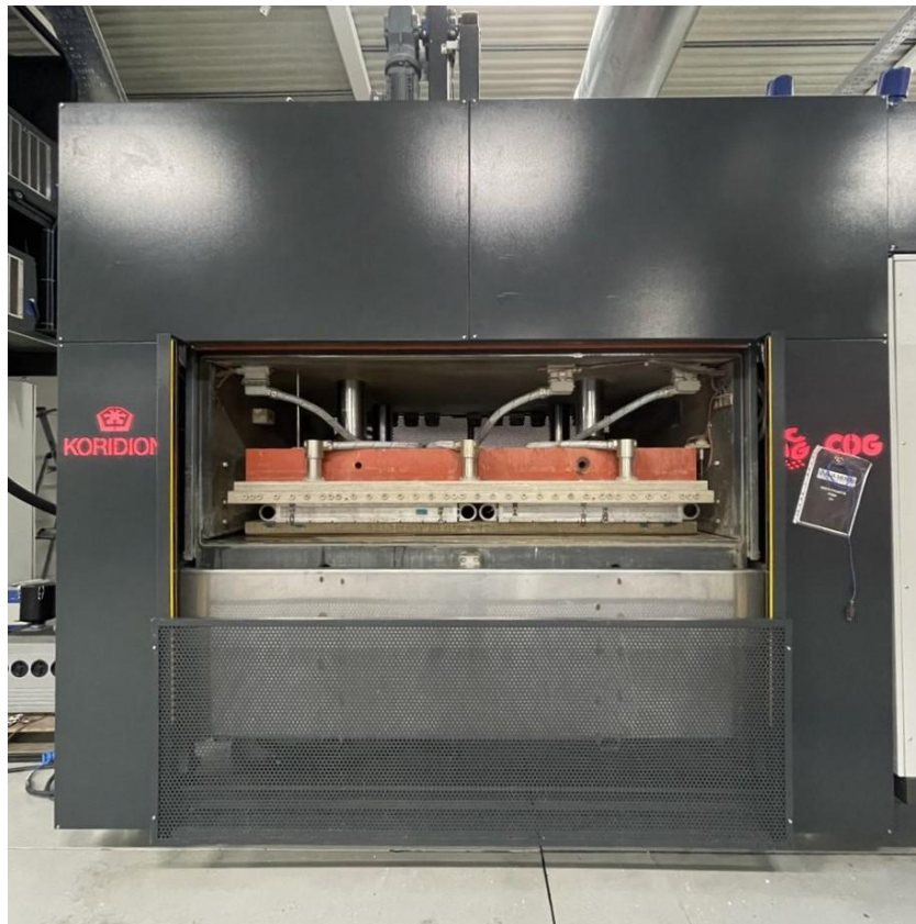
Figura 24: Macchinario "K2.0", vista frontale con stampo in compressione
