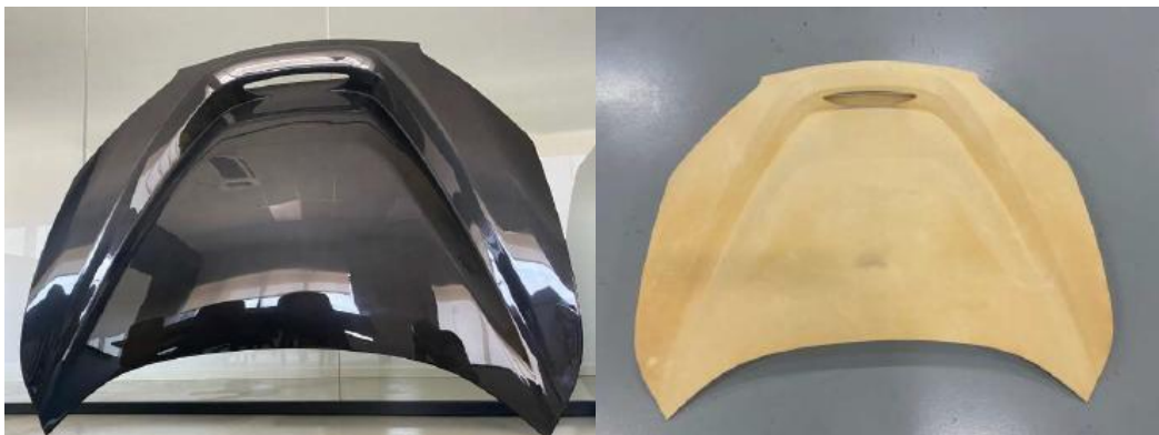
Figura 28: Cofano d'auto in analisi: a sx, pezzo finito; a dx, anima Koridion
