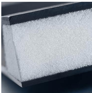
Figura 12: Sezione di un sandwich di CFRP con core Rohacell
