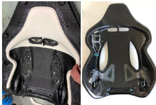
Figura 14: Sedile: a sinistra, anima Koridion inserita nel sandwich in CFRP; a destra, sedile dopo cottura
