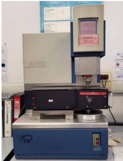
Figura 2.3.1 Reometro ARES della TA Instrument
