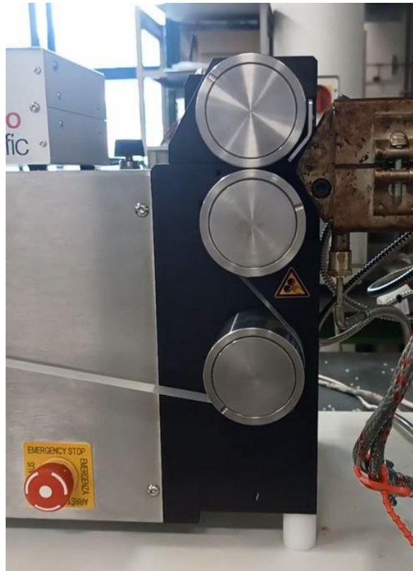
Figura 2.2.17 Sistema di rulli della calandra utilizzata per la produzione di film
