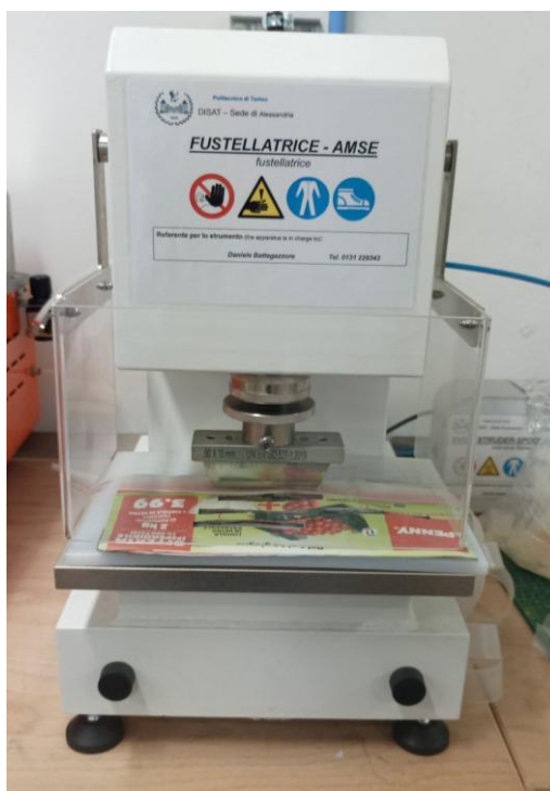
Figura 2.2.18 Fustellatrice pneumatica AMSE con testa UNI EN ISO 627-1 2019
