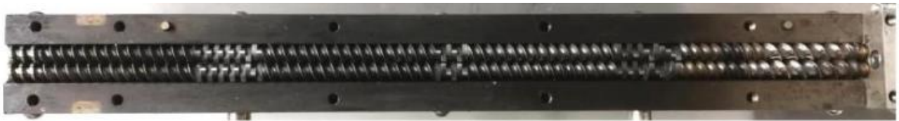
Figura 2.2.16 Vista dall'alto del profilo della vite dell'estrusore bivate Process 11 della TheromFisher
