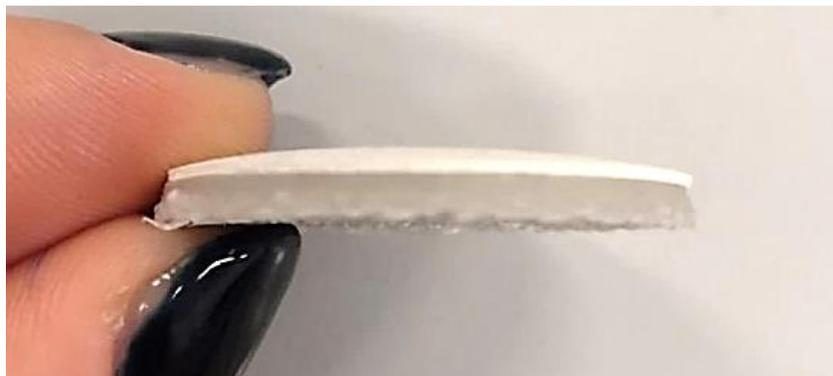
**Figura 3.28** – Vista laterale di un provino 3D, con focus sulla curvatura.
