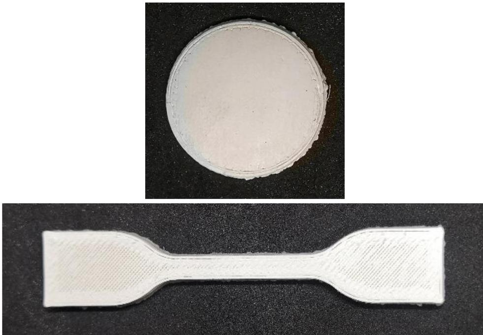
**Figura 3.25** – Provino per analisi termiche all’Hot Disk (a destra); Provino per prove meccaniche (a sinistra).
