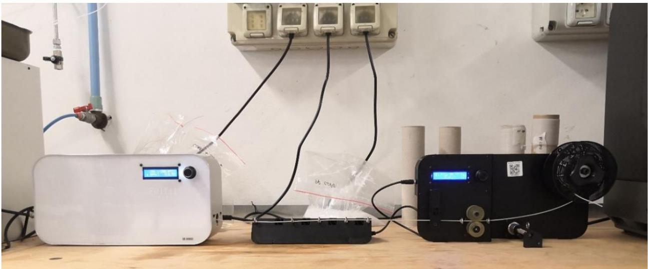
**Figura 2.13** – Estrusore Felfil-evo, con relativo Felfil Spooler.
