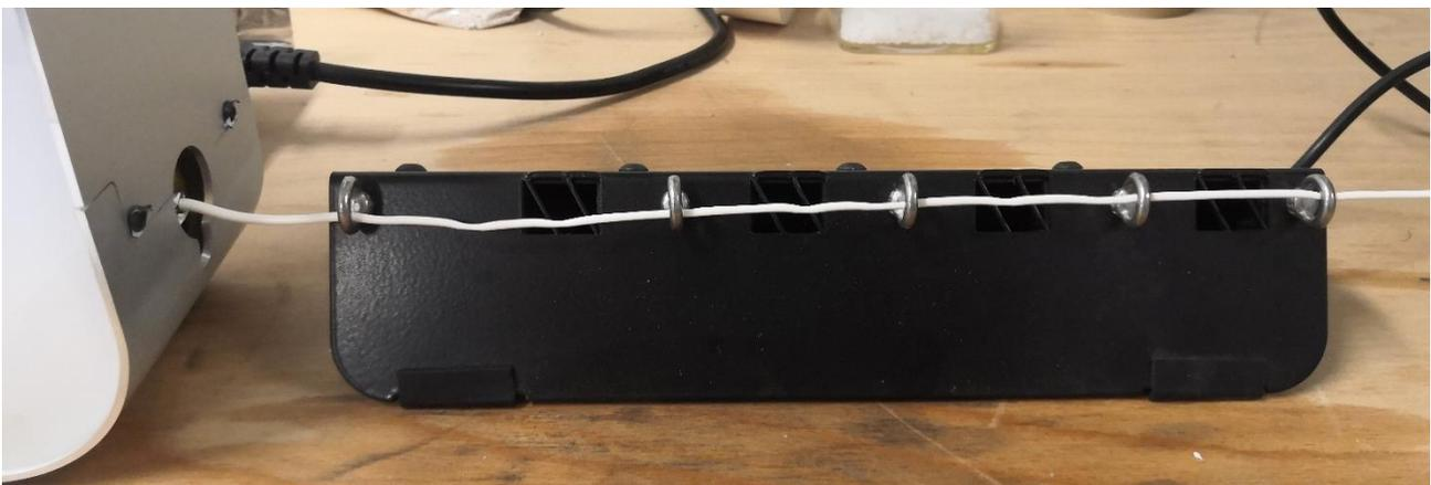
**Figura 2.19** – Esempio di filamento non ottimizzato: il primo anello del sistema di ventole incide sulla linearità del fuso polimerico.
