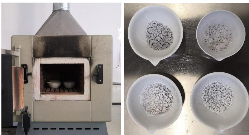
**Figura 2.11** – Forno elettrico a muffola (a sx); Residuo dei pellets dopo il trattamento termico (a dx).
