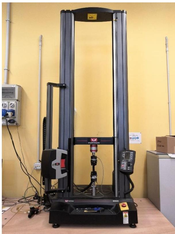
**Figura 2.32** – Dinamometro Instron 5966.
