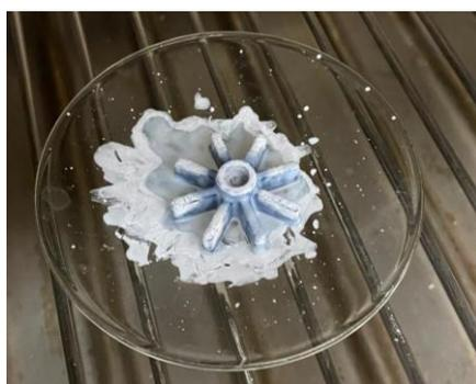
*Figura 6.20 - Supporto 3D ricoperto di MOF con metodo ink*
