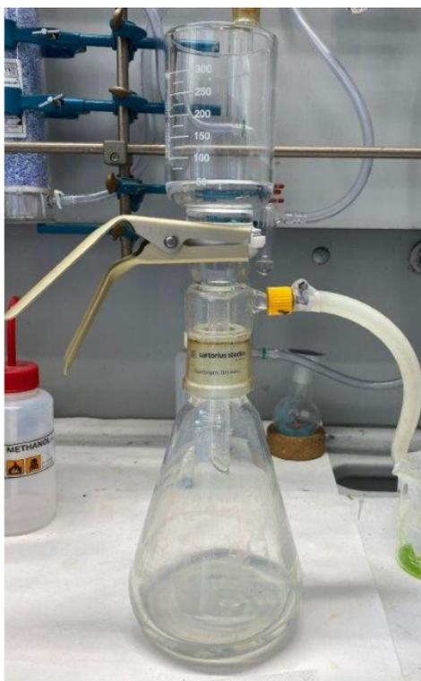
*Figura 6.2 - Apparecchiatura per la filtrazione del MOF-808*
