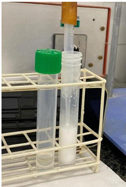
*Figura 6.19 - Evaporazione dell'acetone dalla dispersione preparata per metodo ink*
