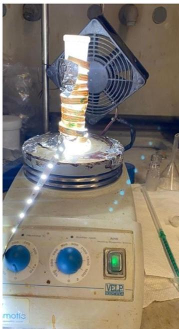
*Figura 8.7 - Sistema di reazione fotocatalitico con striscia di LED visibili*
