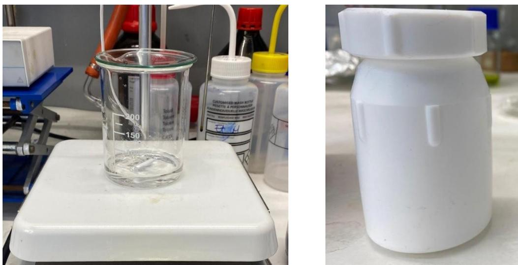
**Figura 6.1** - Sale di zirconio in agitazione con DMF (a sinistra) e bomba idrotermale (a destra)
