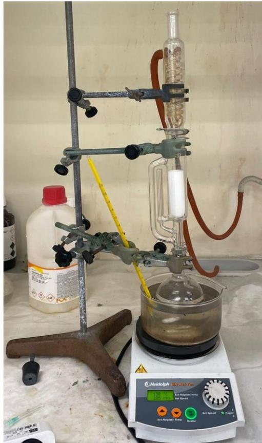
*Figura 8.5 - Estrattore Soxhlet per attivazione del MOF Ce-UiO-66-NH<sub>2</sub>*
