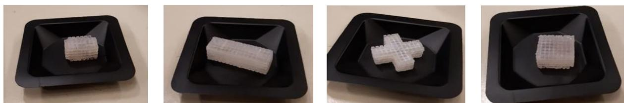
**Figura 7.3** - Supporti 3D ricoperti con MOF in ordine di prova (rispettivamente supporto 1, 2, 3 e 4)
