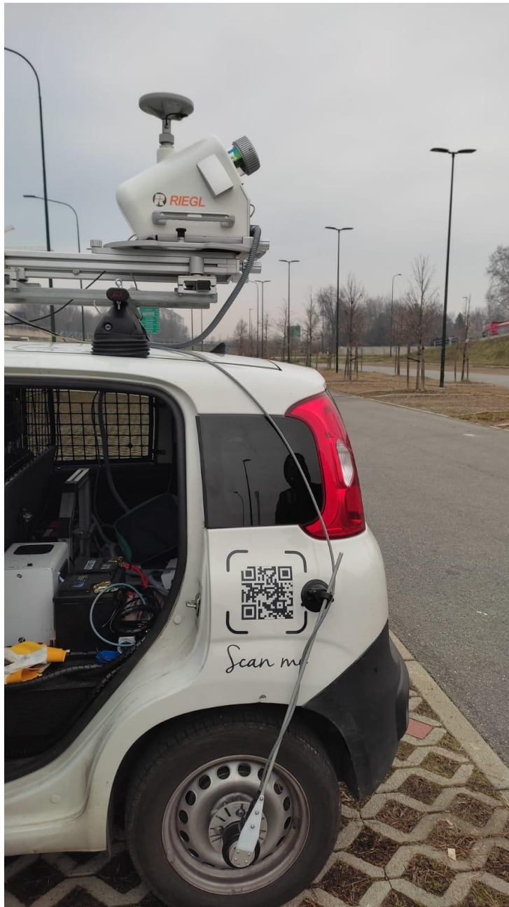
Figura 58 – Veicolo Digitarca, ben visibile il DMI collegato alla ruota
