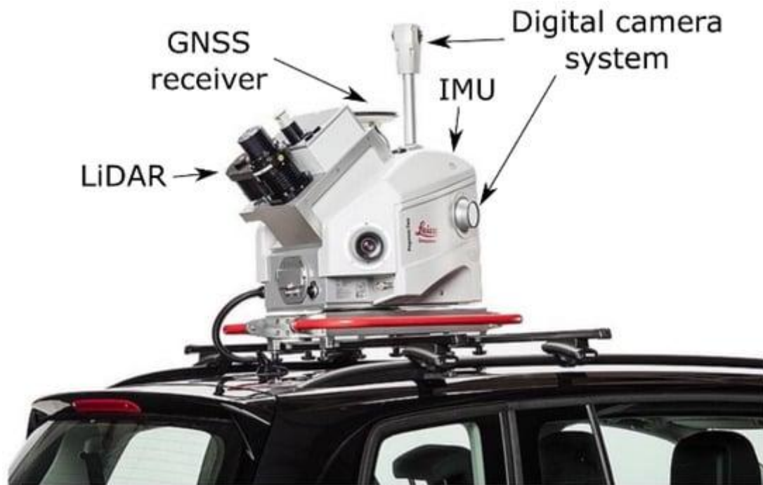
Figura 51 – Un esempio di attrezzatura MMS: una piattaforma di mappatura mobile montata su veicolo, composta da diversi sensori di posizionamento e raccolta dati per generare una mappa 3D accurata e georeferenziata dell'ambiente. Qui sono mostrati i principali sensori del Leica Pegasus: Two Ultimate come esempio.
