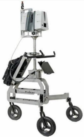
Figura 54 – Esempio MMS su carrello, Leica ProScan
