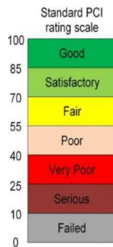
Figura 88 – Classificazione e colori collegati al valore del PCI
