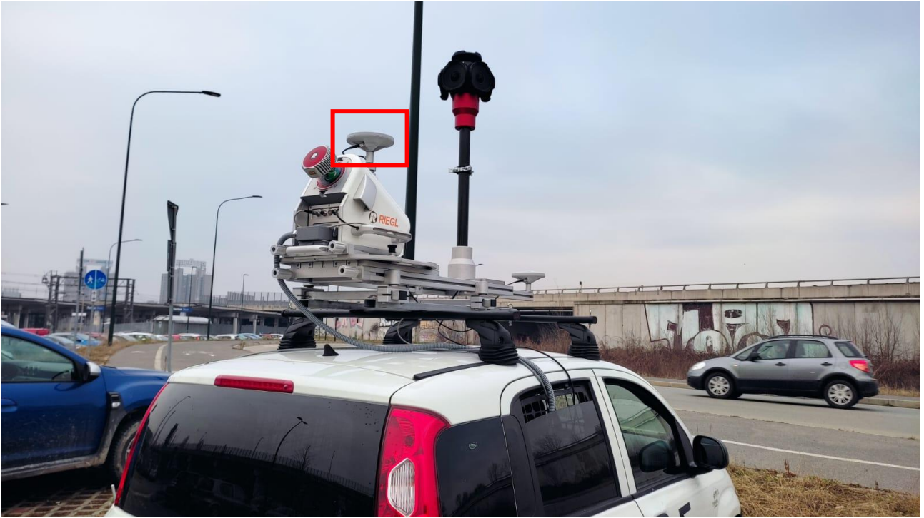
Figura 59 – Sistema MMS montato su veicolo Digitarca, inquadramento sistema GNSS
