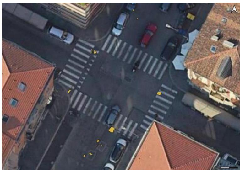
Figura 71 – Visualizzazione delle sole depressioni stradali, zoom sull'incrocio centrale
