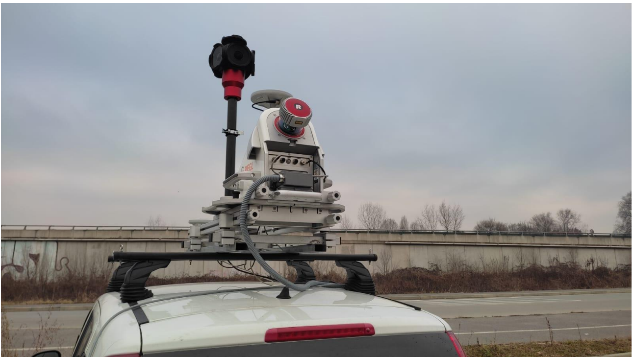
Figura 60 – Sistema MMS montato su veicolo Digitarca
