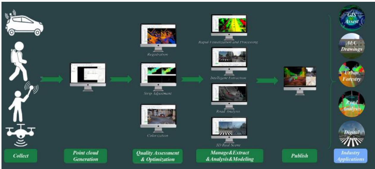
Figura 80 – schema concettuale dalla raccolta dati al loro utilizzo passando tramite l'utilizzo del software
