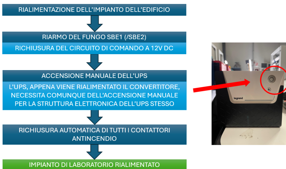
Figura 6-19: Procedura di riarmo dell'impianto nel caso di intervento dei Vigili del Fuoco
