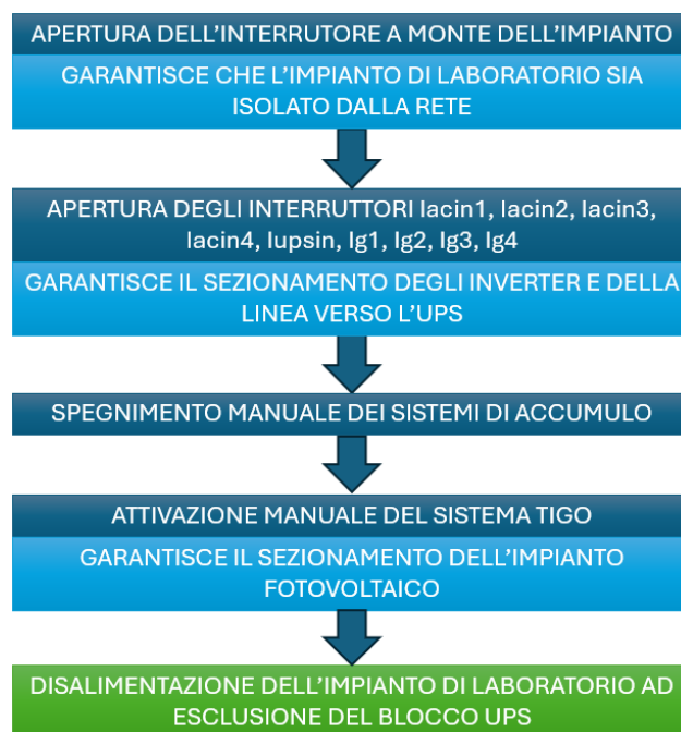
Figura 6-7: Procedura per la disalimentazione dell'impianto di laboratorio ad esclusione del blocco UPS nella soluzione 1
