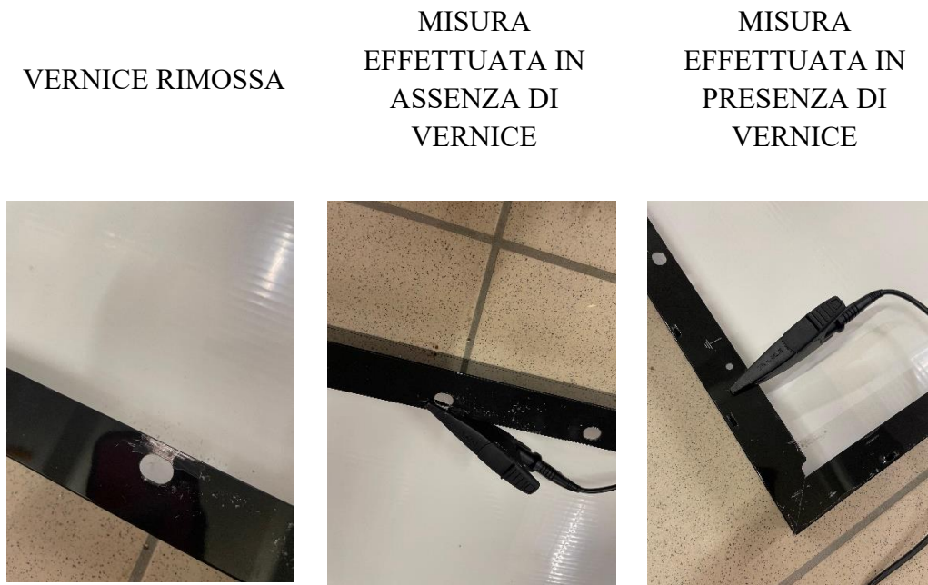
Figura 7-3: Verniciatura della carcassa del modulo LG
