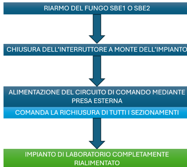
Figura 6-10: Procedura per la rialimentazione totale dell'impianto di laboratorio nelle soluzioni 1 e 2
