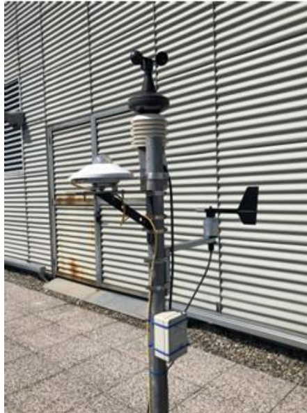
Figura 4-13: Strumentazione per la misura delle variabili meteorologiche [1]
