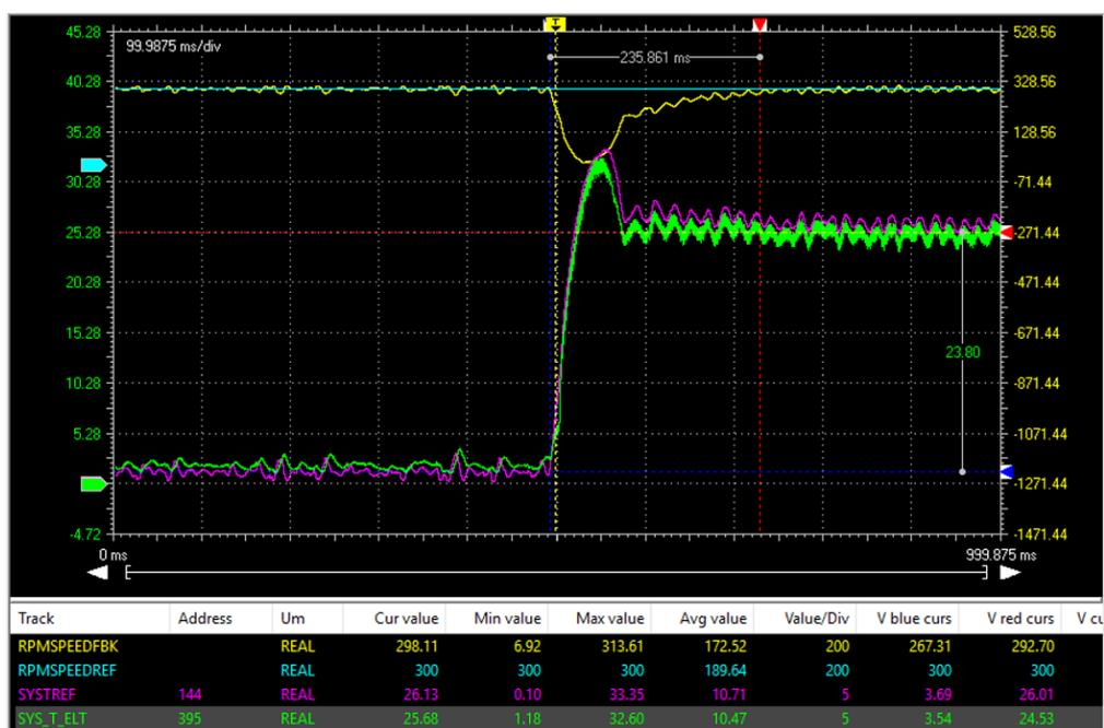
**Figura 7.12:** Risposta del controllo FOC al gradino di carico alla coppia nominale a 300 rpm con banda 10 Hz
