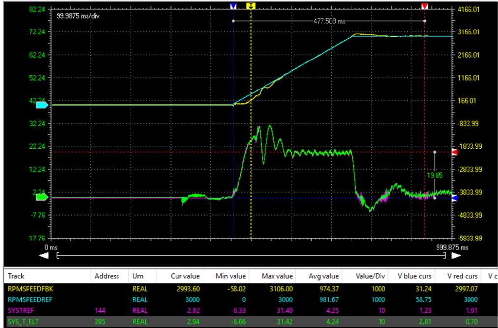
**Figura 7.15:** Risposta del controllo DFVC allo spunto in assenza di carico fino alla velocità nominale in 300 ms
