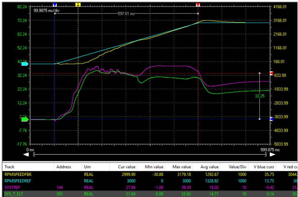
**Figura 7.16:** Risposta del controllo FOC allo spunto a carico fino alla velocità nominale in 600 ms
