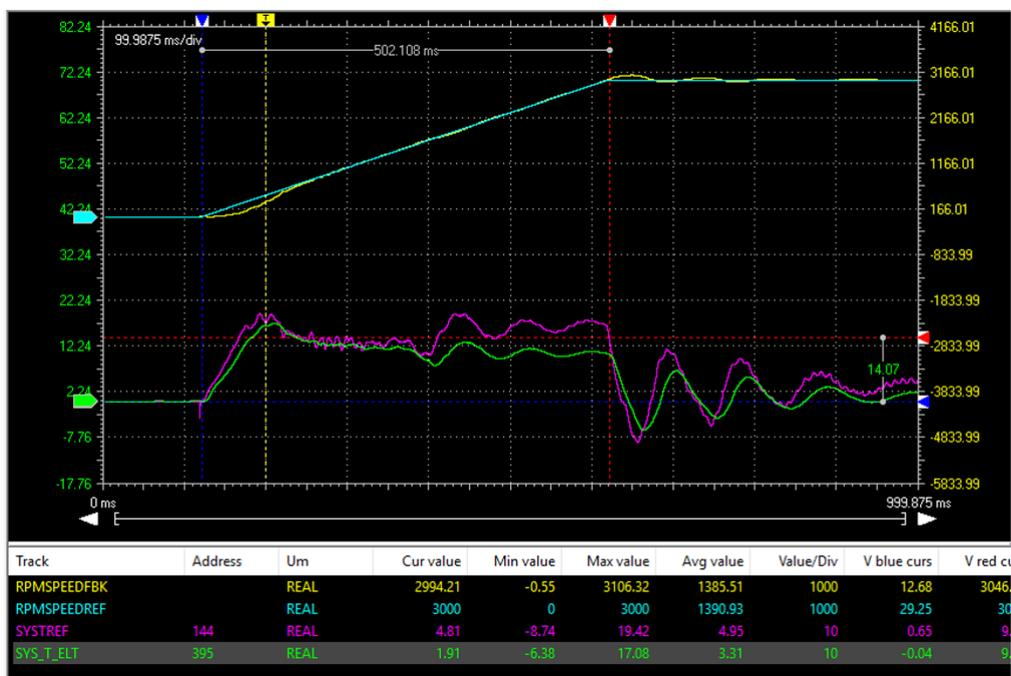
**Figura 7.17:** Risposta del controllo FOC allo spunto in assenza di carico fino alla velocità nominale in 500 ms
