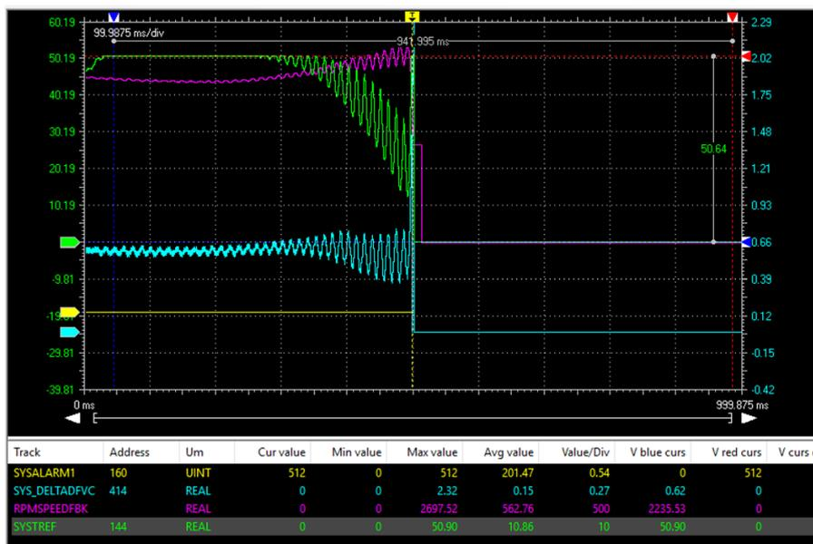
Figura 7.23: Controllo DFVC allo scarico di coppia
