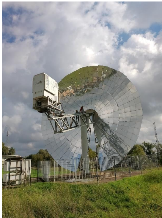
Figure 8 - Parabolic dish collector in Centro Ricerche Casaccia (ENEA)
