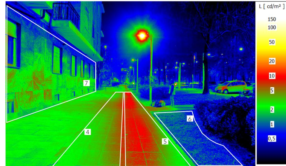
L'immagine in falsi colori descrive, nel caso di Corso Castelfidardo, un ambiente molto illuminato in cui il flusso luminoso si concentra principalmente su una corsia del percorso ciclabile dove sono presenti dei valori di luminanza massima di  $L_{max,1}=14.01 \text{ cd/m}^2$ .
