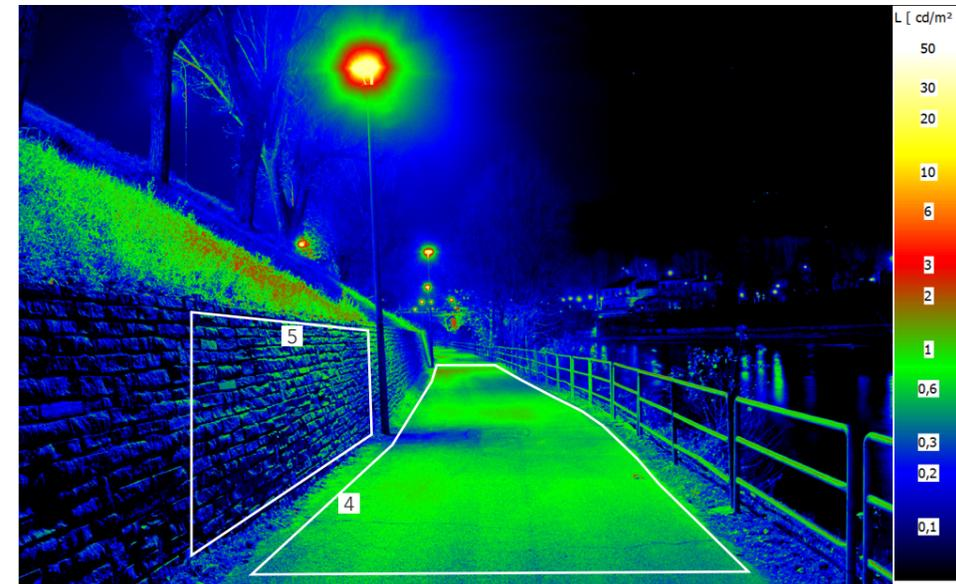
Il percorso lungo il fiume Po risulta illuminato uniformemente e la luminanza media è pari a  $L_{\text{mean},1}=0.56 \text{ cd/m}^2$ .
