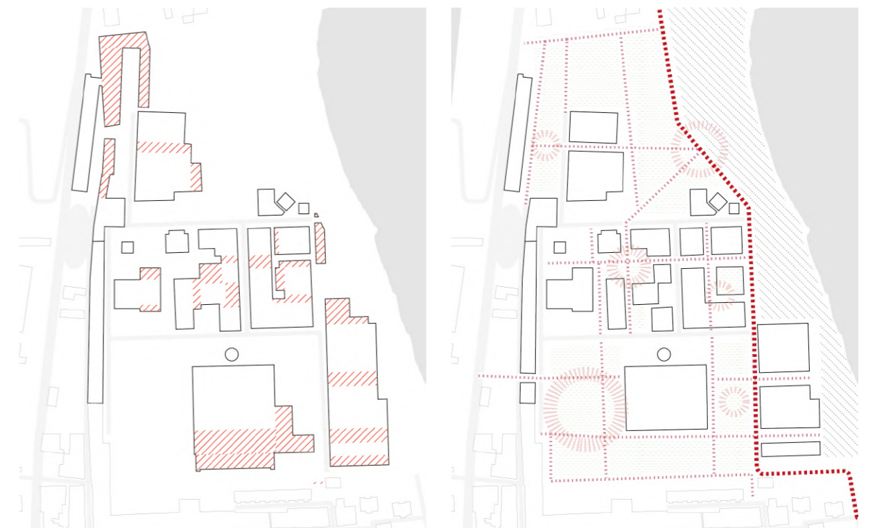
Figura 90, 91. Planimetria generale della Chimica Arenella, schemi di concept progettuali. Demolizioni e nuova viabilità interna. Rielaborazione grafica personale.
