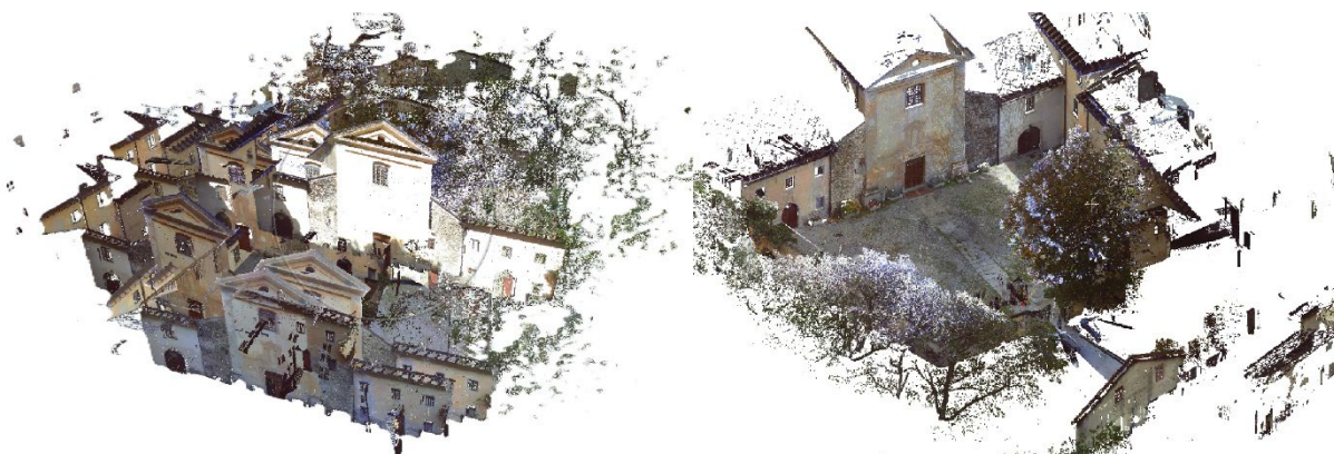
Figura 33 Scansioni non allineate a sinistra, nuvola di punti unica georeferenziata/ottimizzata a destra.
