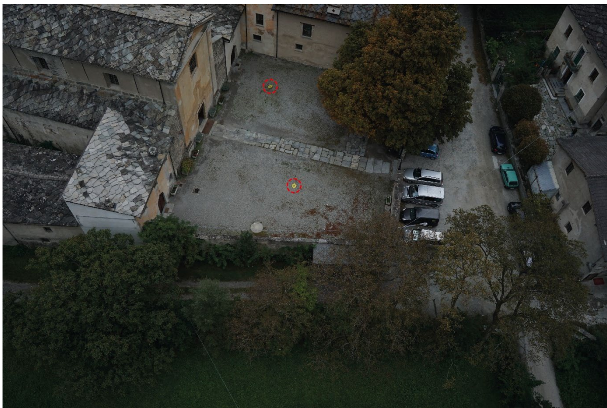
Figura 20 punti di appoggio all'interno del sagrato dell'abbazia di Novalesa.
