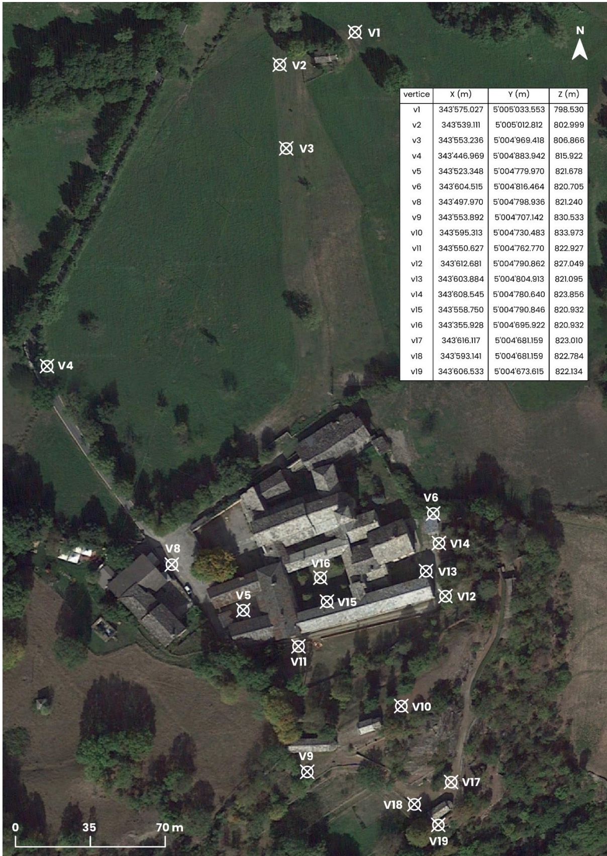
Figura 17 Vertici misurati per la rete topografica (Patrucco 2016).
