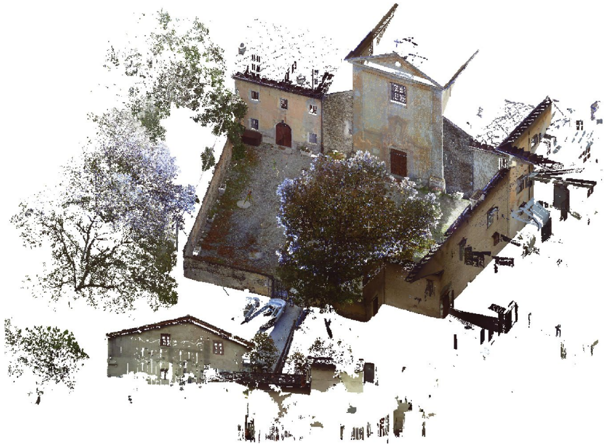
Figura 38 Nuvola ottenuta tramite metodo fotogrammetrico dell'abbazia della Novalesa (in alto) e nuvola ottenuta mediante laser scanner distanziometrico terrestre della porzione riguardante il sagrato e prospetto principale della Chiesa Santi Pietro e Andrea (in basso).
