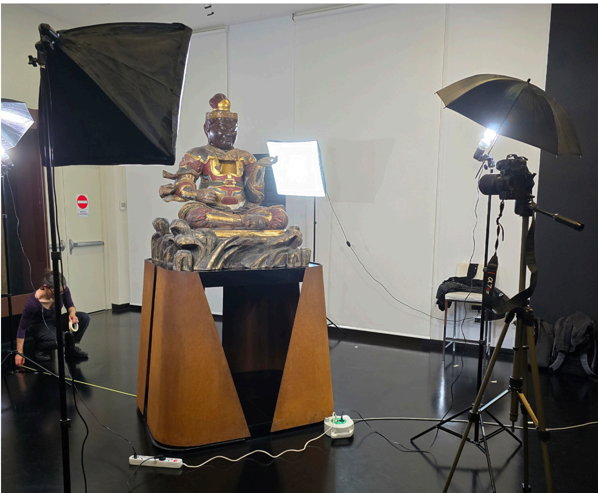
Fig. 41: Rilievo di fotogrammetria eseguito al MAO per creare il modello 3D di Tamon-Ten
