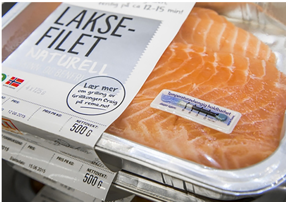
Figura 9: etichetta indicatore di freschezza e temperatura tempo.
