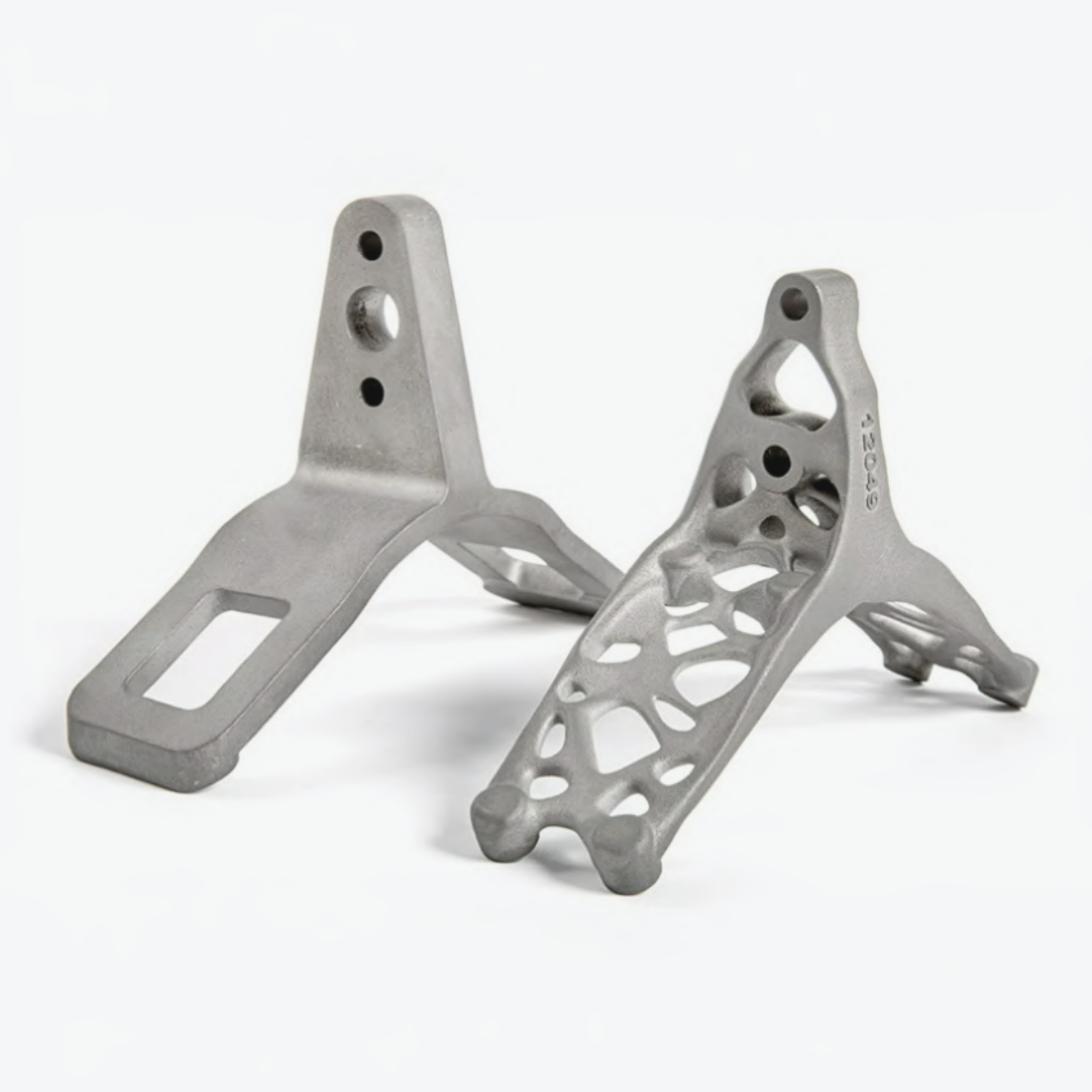
Figura 5.5 Componente metallico realizzato con la geometria di partenza (sinistra) e con la geometria ottimizzata topologicamente (destra) [138].
