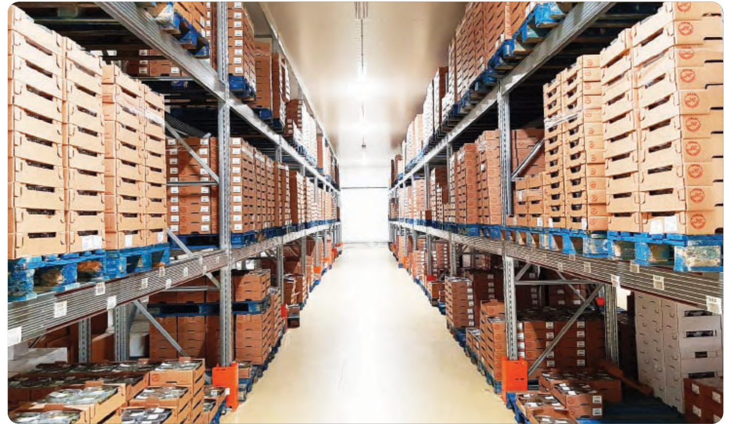
Figura 6.13 Magazzino con scaffalature metalliche ad incastro per pallet [180].
