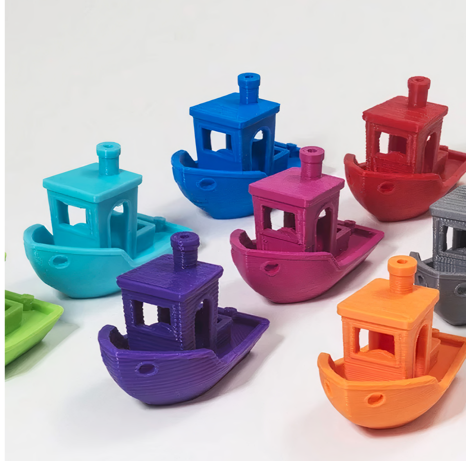
Figura 4.15 Pezzi stampati in PLA di diversi colori del modello 3D Benchy [108].
