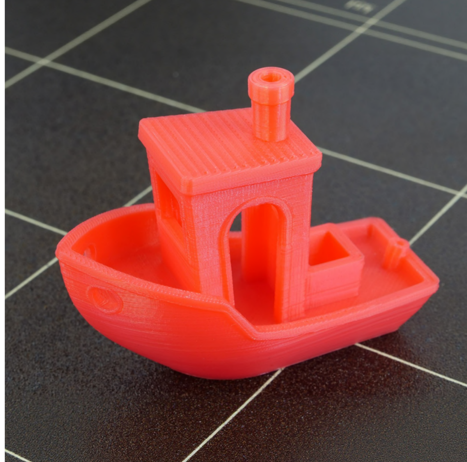
Figura 4.23 3D Benchy, il più famoso modello STL per effettuare test qualitativi delle stampanti 3D, Creative Tools, 2015 [119].
