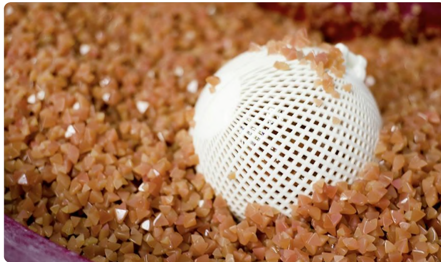
Figura 4.12 Tecnica di finitura vibratoria, in cui il componente è immerso in una vasca con pietre abrasive [101].
