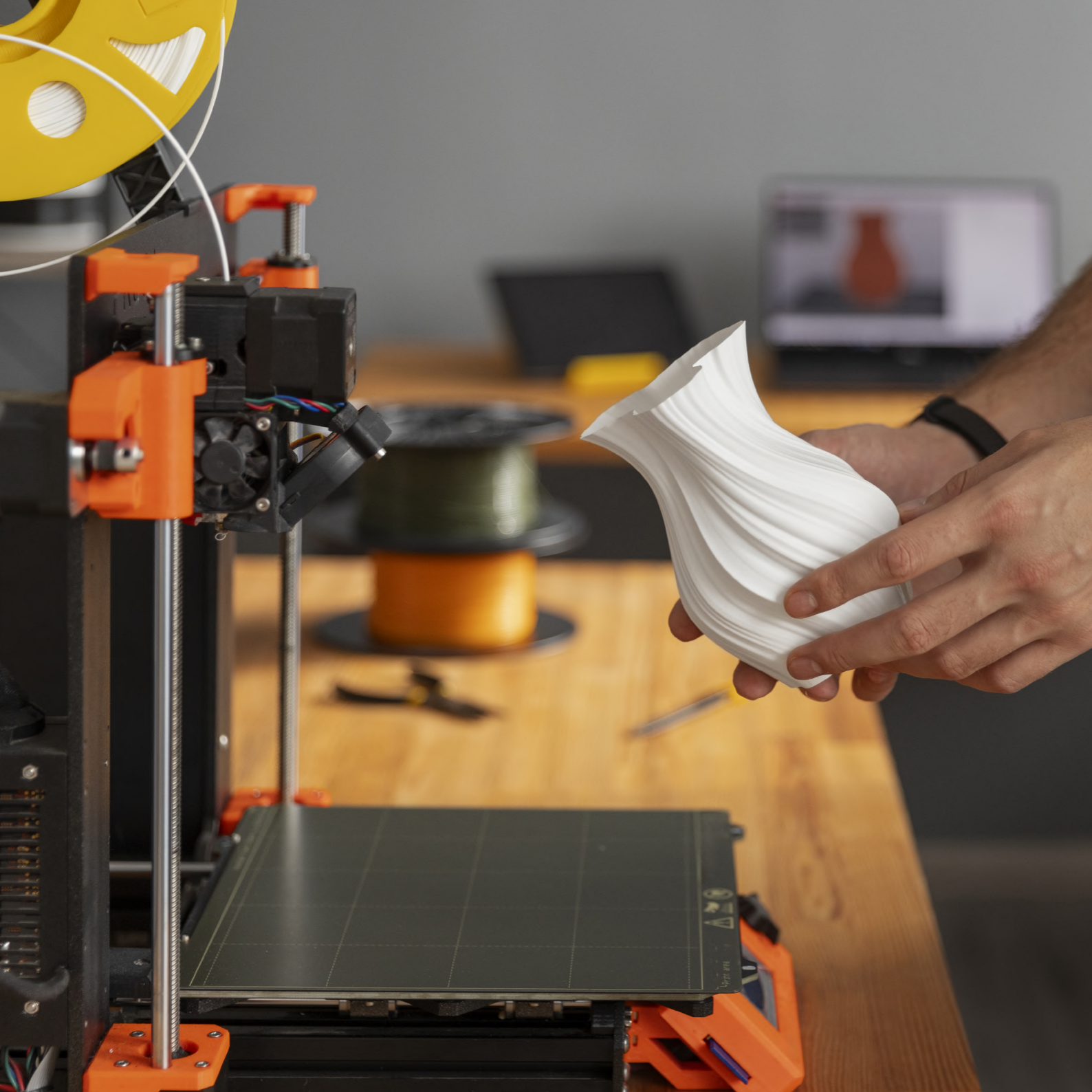
Figura 4.25 Rimozione di un oggetto stampato in 3D con una stampante FDM domestica [121].
