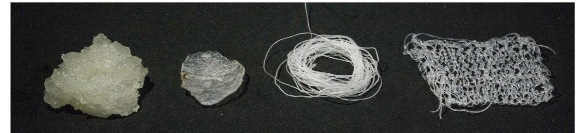
Sopra: Trasformazione del biomateriale da pasta, a filato e poi a pannello di maglia per tessuti. A lato: Alga Kelp.
