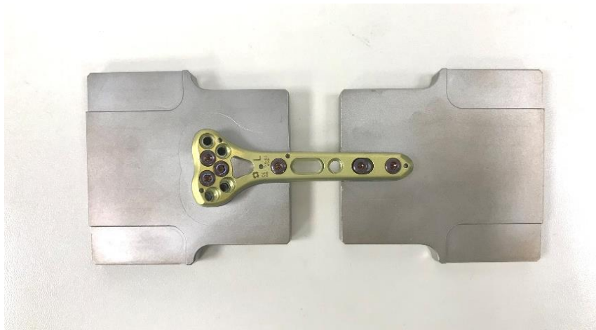
Figura 40: Estensioni per il corretto fissaggio della placca e setup del dispositivo di test. In alto le estensioni realizzate in SolidWorks; in basso la placca fissata ad esse
