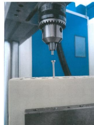
Figura 45: Apparato di test per la determinazione della torsione di avvitamento e svitamento
