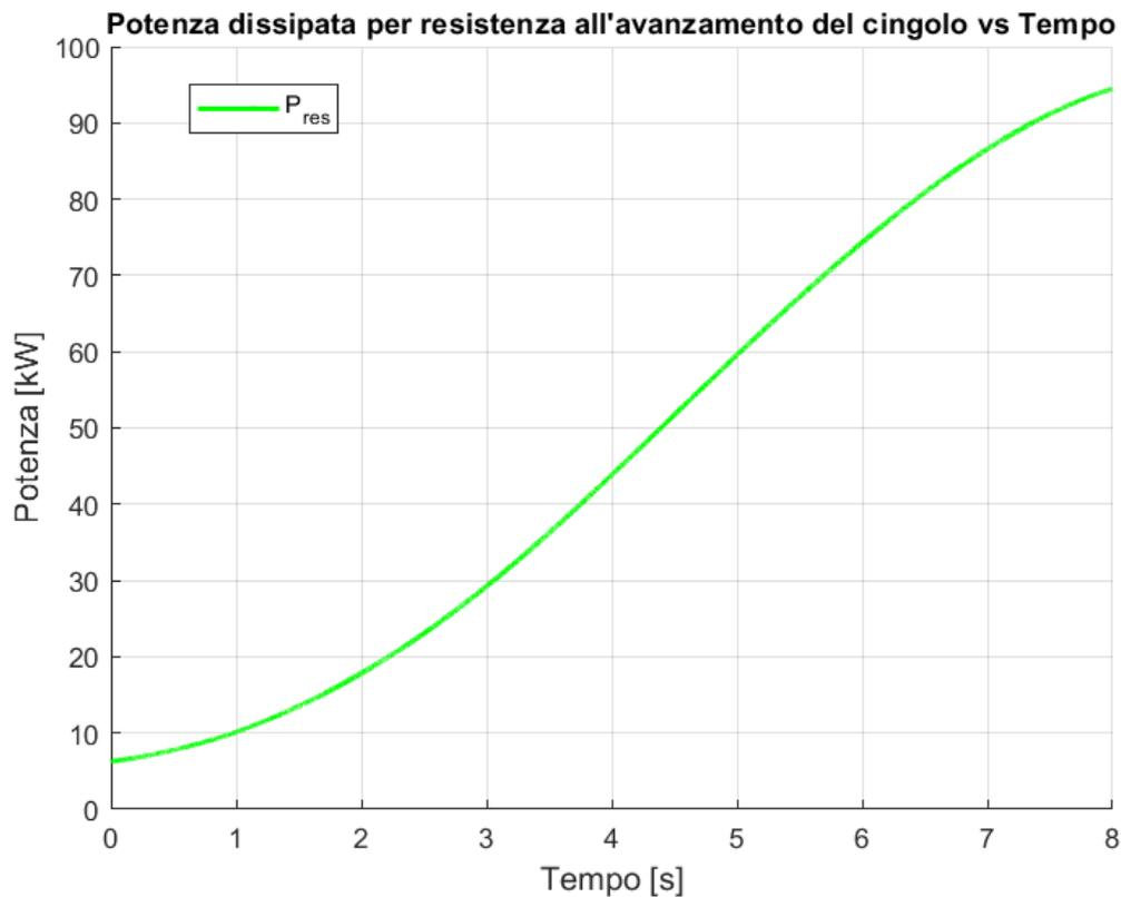
**Figura 8.21** - Potenza dissipata per resistenza all'avanzamento del cingolo vs Tempo (veicolo cingolato con cinque road wheels)
