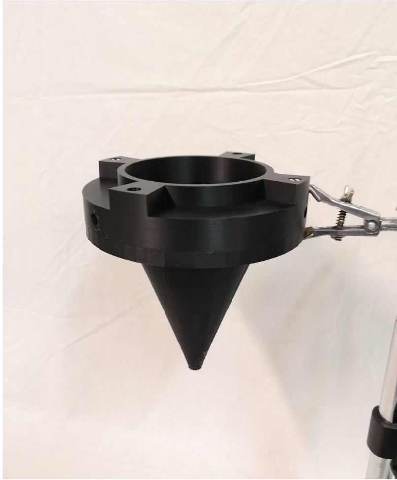
Figura 35 - imbuto con nuovo anello di distribuzione dell'acqua
