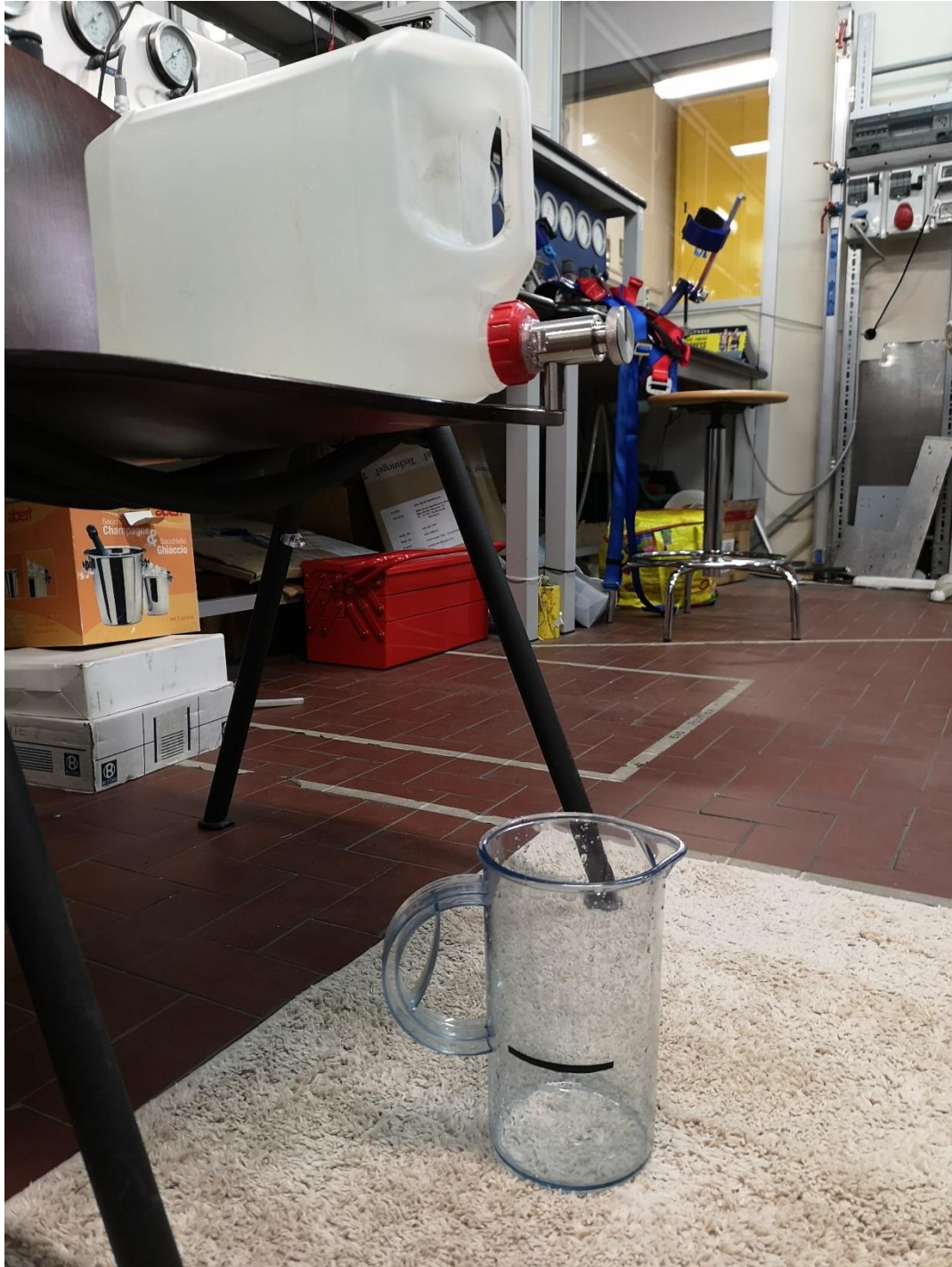
Figura 16 - caraffa graduata al di sotto del rubinetto integrato alla tanica
