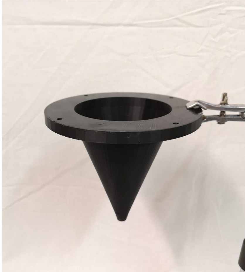
Figura 27 - imbuto di raccolta ottenuto tramite stampa 3D
