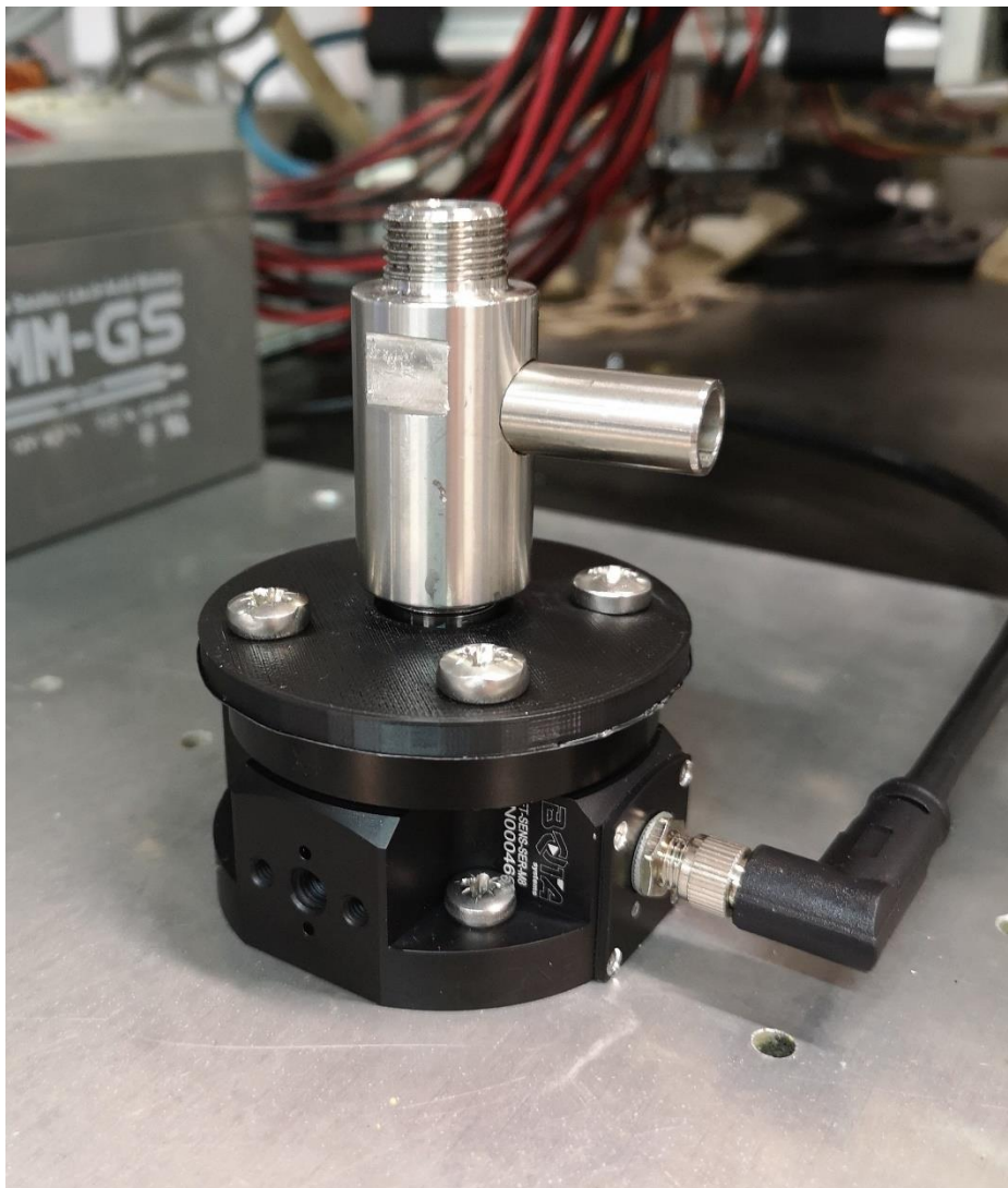
Figura 9 - rubinetto fissato alla cella di carico
