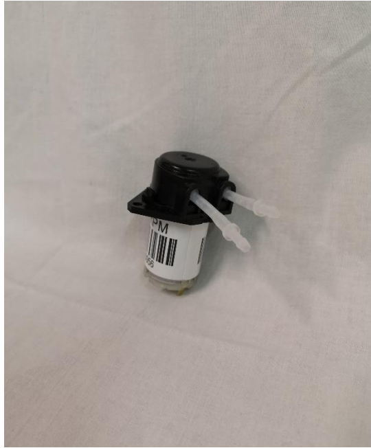
Figura 37 - pompa peristaltica usata per lo scarico dell'imbuto
