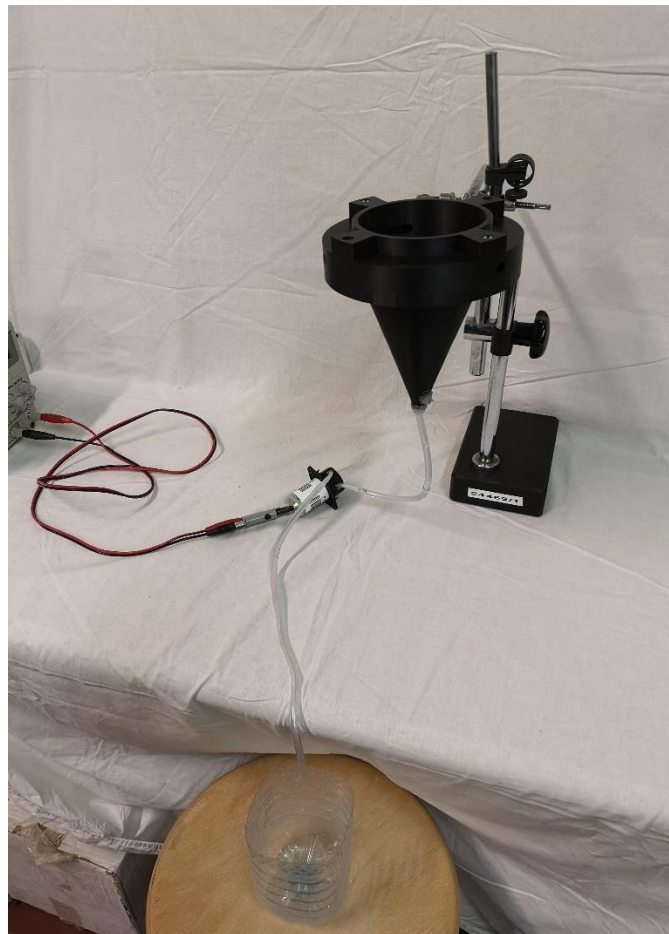
Figura 38 - circuito per testare la pompa di scarico
