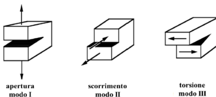
Figura 1.9. Schema delle tre modalità di apertura possibili del composito laminato [7]
