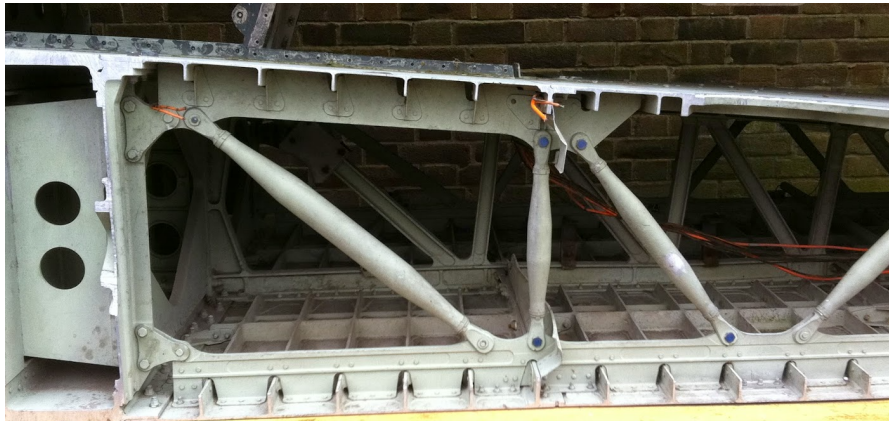
Figura 1.3: Struttura alare reale [2]
