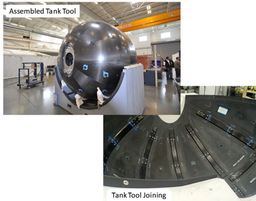
Figura 1.8: Serbatoio in composito testato da NASA [5]
