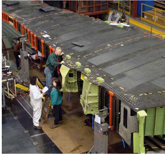
Figura 1.6: Particolare dell'ala in composito del 787 [11]
