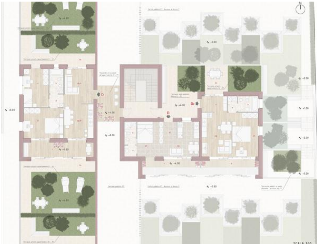
Esempio di pianta del piano primo di uno dei quattro blocchi modulari
