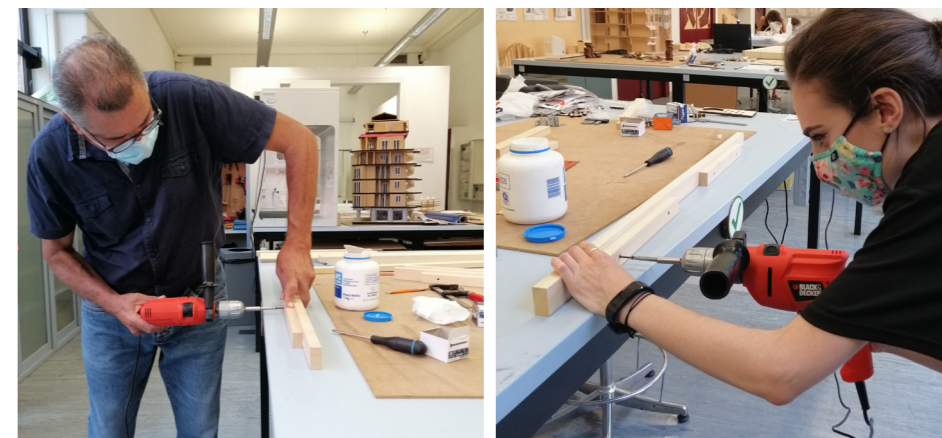
Fig. B14 B15 Costruzione degli elementi della cornice perimetrale con i sostegni per la griglia di gioco mediante incollaggio e fissaggio con viti.
