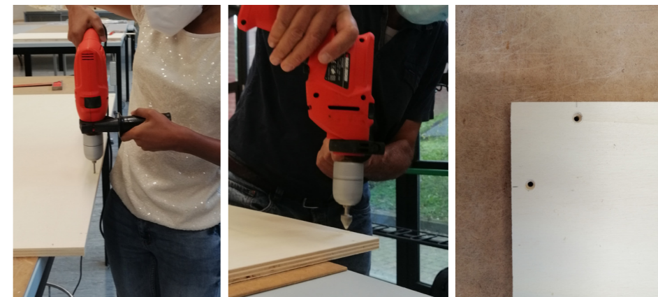
Fig. B11 B12 B13 Foratura del pannello di base e rifinitura del foro per il fissaggio dei profili perimetrali con viti filettate.
