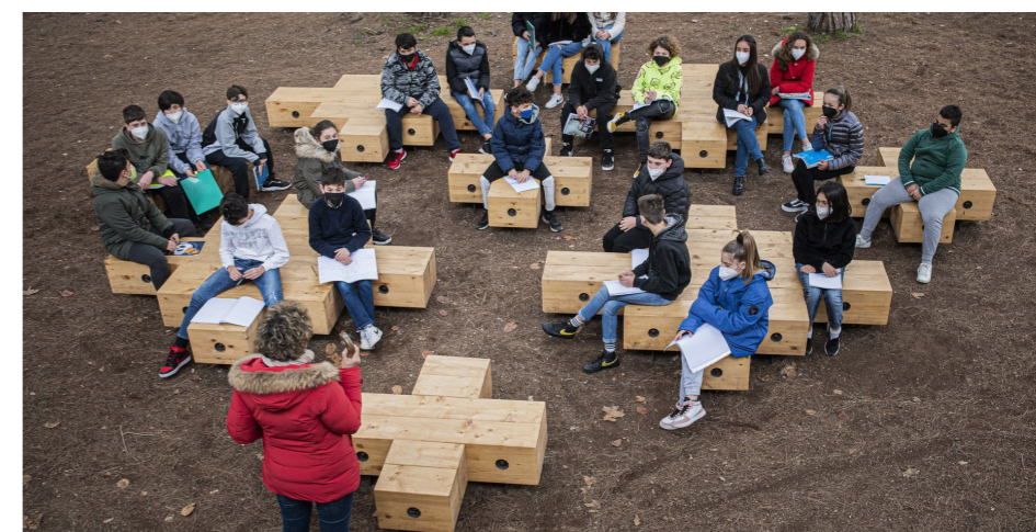
Fig. 15_ Progetto "Aria", esempio di Aula all'aperto progettata nel 2021 dallo studio ECÒL per la scuola media Bugiani, nell'area ex Ilva, Comune di Follonica (GR). La struttura delle sedute è costituita da travi in legno lamellare di abete, incernierate mediante barre filettate in acciaio.
