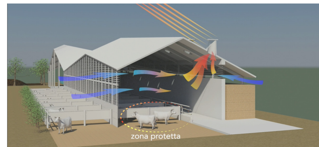
Fig.2 Schema bioclimatico della ventilazione naturale nella stalla
