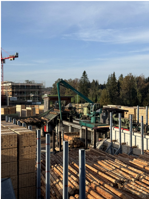
(I14) Macchinario che posiziona i tronchi sulla macchina di taglio
