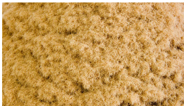
[447] Polvere ricavata dalla lavorazione dei pannelli di fibra di legno compressa (Fonte: Fibradilegno.com)
