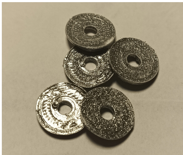
(471) Rondelle posizionate tra uno strato e l'altro degli archi
