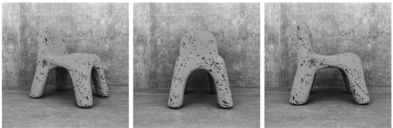
(39) Sedia stampata in 3D con lettere come pattern (Fonte: architectonics and parametric thinking pp. 46)
