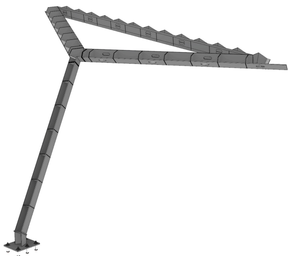
(I10) Telaio principale del padiglione (Fonte: Encode.io).
