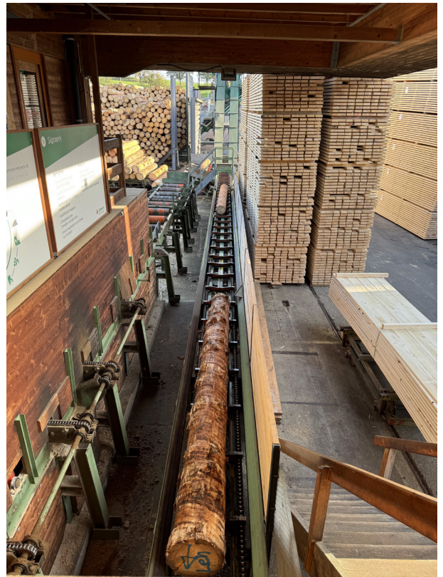
(I15) Macchinario per trasportare i tronchi alle macchine di taglio
