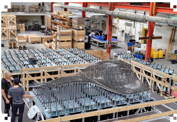
(350) Sistema di piegatura del corian basato sui pistoncini e un letto flessibile (Fonte: Parametric architecture)
