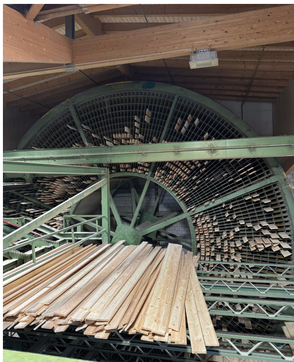
(I18) Ruota dove vengono posizionati gli assi irregolari in attesa di misure simili
