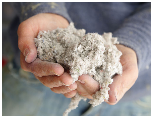
(346) Fibra di cellulosa vista da vicino (Fonte: Isolacasa.it)
