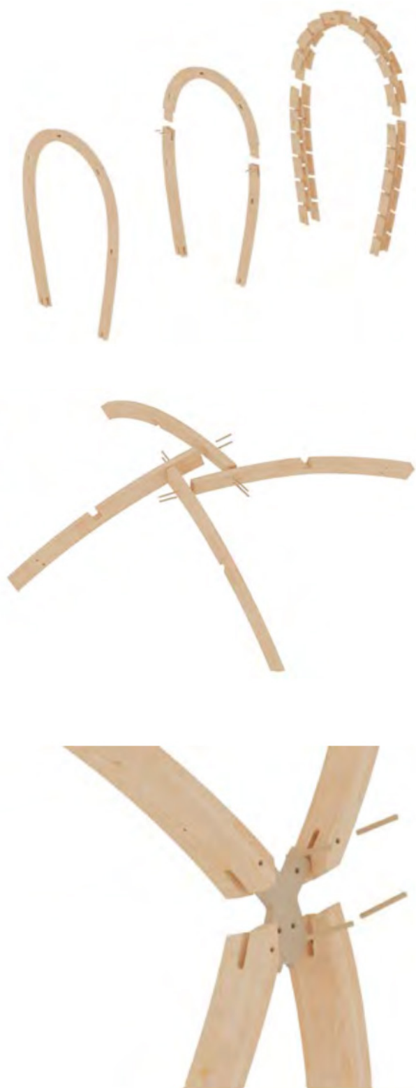
(60-62) Esplosi archi e incastri strutturali (Fonte: fabricate 2024 pp. 102)
