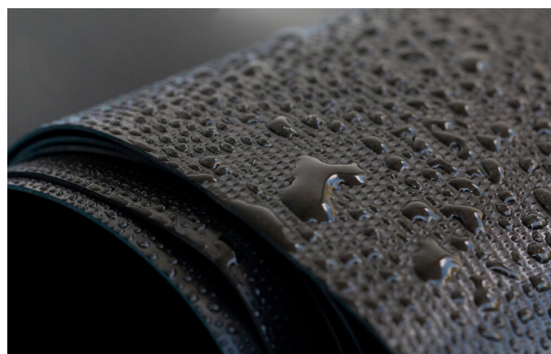
(348) EPDM gomma utilizzata come strato anti risalita (Fonte: Betelli.it)
