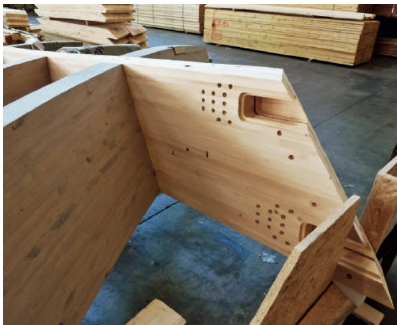
[55] Esempio di trave lavorata a controllo numerico (Fonte: bridging the gap from cad to cam: concepts, caveats and a new grasshopper plug-in pp. 8)
