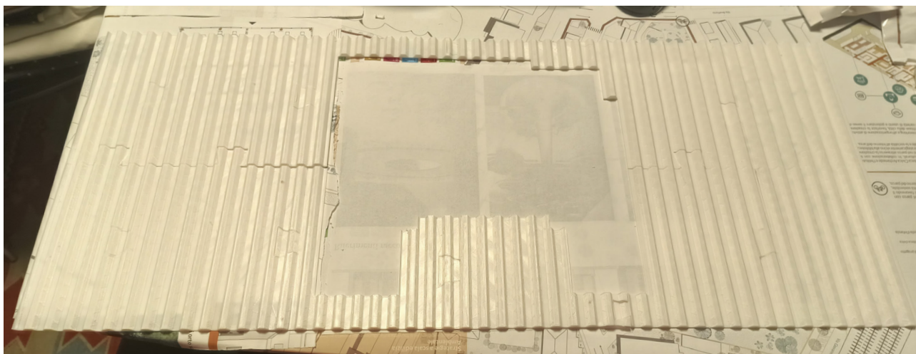
(473) Solaio in lamiera grecata prima metà stampata in 3D
